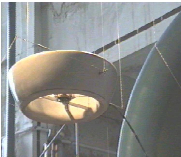
Рис. 3. Установка модели в рабочей части аэродинамической трубы Т-1 МАИ
