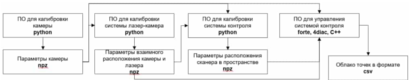
Рисунок 20 — Схема взаимодействия компонентов ПО для прототипа системы сканирования
