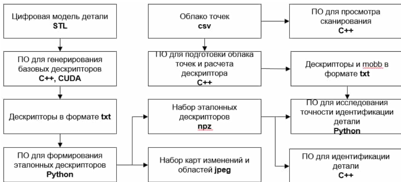
Рисунок 47 — Схема взаимодействия компонентов ПО для идентификации деталей
