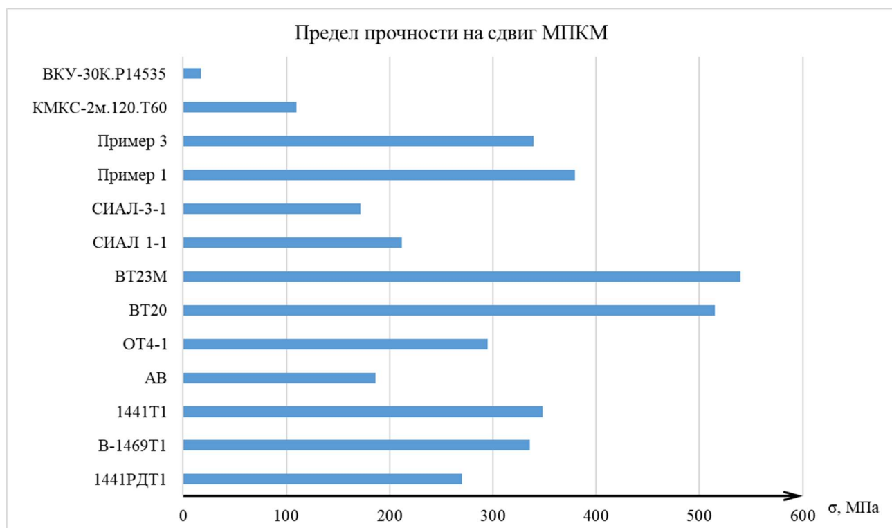
Рисунок 2.7 – Сравнение паспортных характеристик предела прочности на сдвиг МПКМ с металлами и ПКМ
