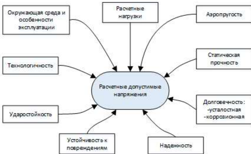
Рисунок 4.7 – Факторы, влияющие на выбор величины допустимых напряжений в конструкции планера самолета
