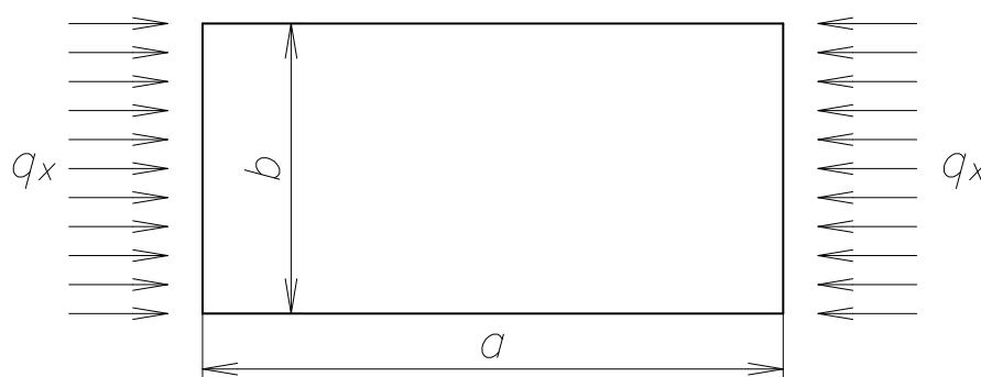
Рисунок 3.6 – Расчетная схема нагружения пакета МПКМ
