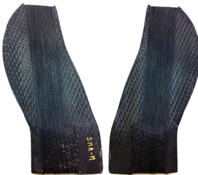
Рисунок 1.17 – Углепластиковые лопасти, армированных никелидом титана [92].
