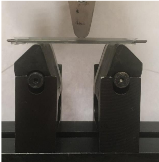
Рисунок 3.8 – Схема испытаний на трехточечный изгиб.
