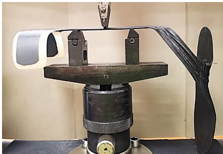
Рисунок 5.5 – Схема испытаний на изгиб упругого элемента стоподержателя.
