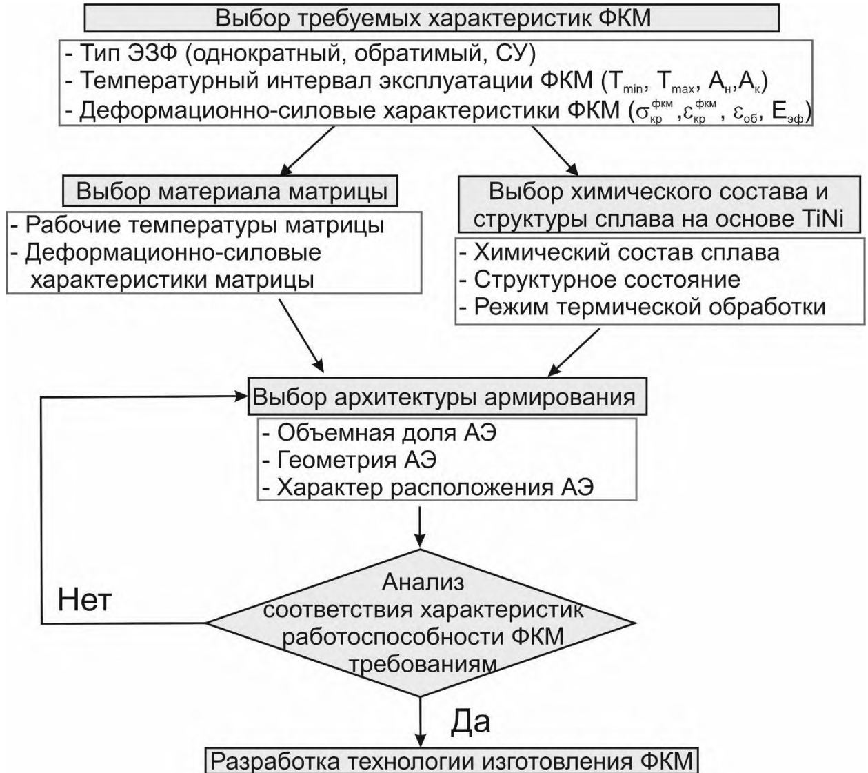
Рисунок 5.1 – Алгоритм разработки ФКМ.
