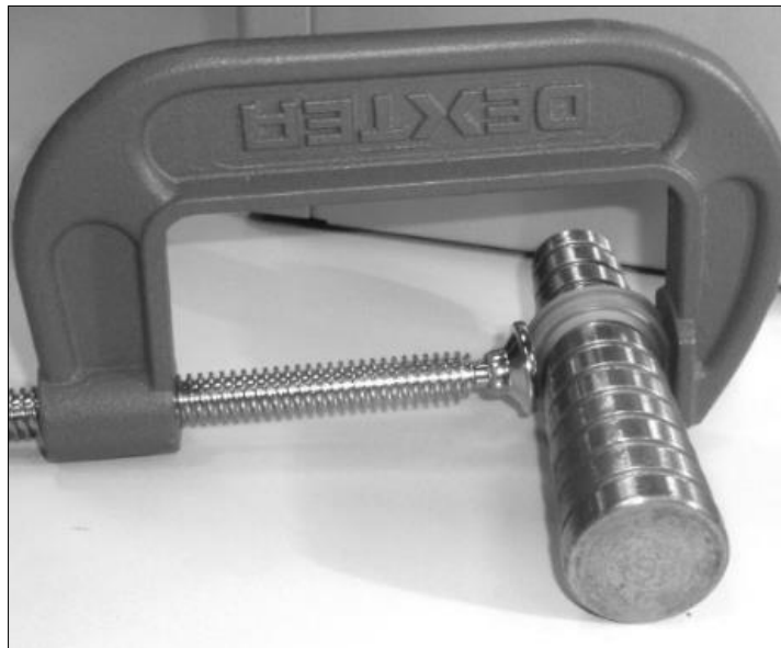
Рисунок 3.12 – Деформирование образцов ФКМ вокруг цилиндрической оправки.
