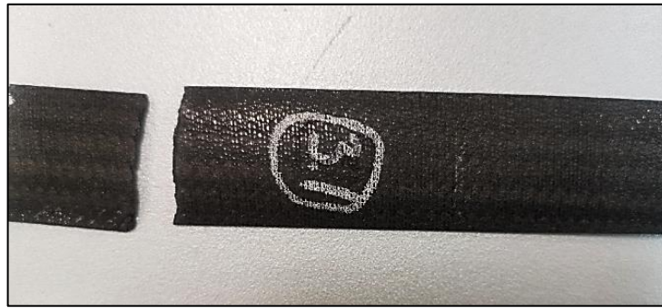
Рисунок 3.18 – Внешний вид образца неармированного углепластикового КМ с 9 слоями после испытаний на трехточечный изгиб.
