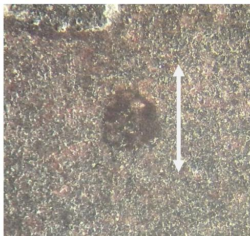
Рисунок 4.52 – Пятно повреждения МДО покрытия при  $F_n = 150\text{Н}$  и  $D = 150\text{мкм}$
