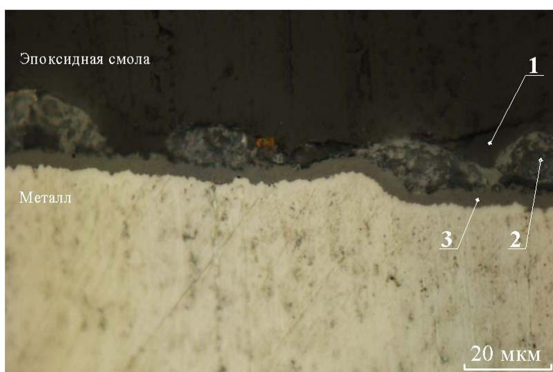
Рисунок 4.20 - Изображение поперечного сечения МДО покрытия, сформированного в электролите, содержащем КОН – 8г/л и  $K_2SiO_3$  – 6г/л, на циркониевом сплаве Э110 (1 – Эпоксидная смола, 2 – Внешний слой, 3 – Внутренний слой)
