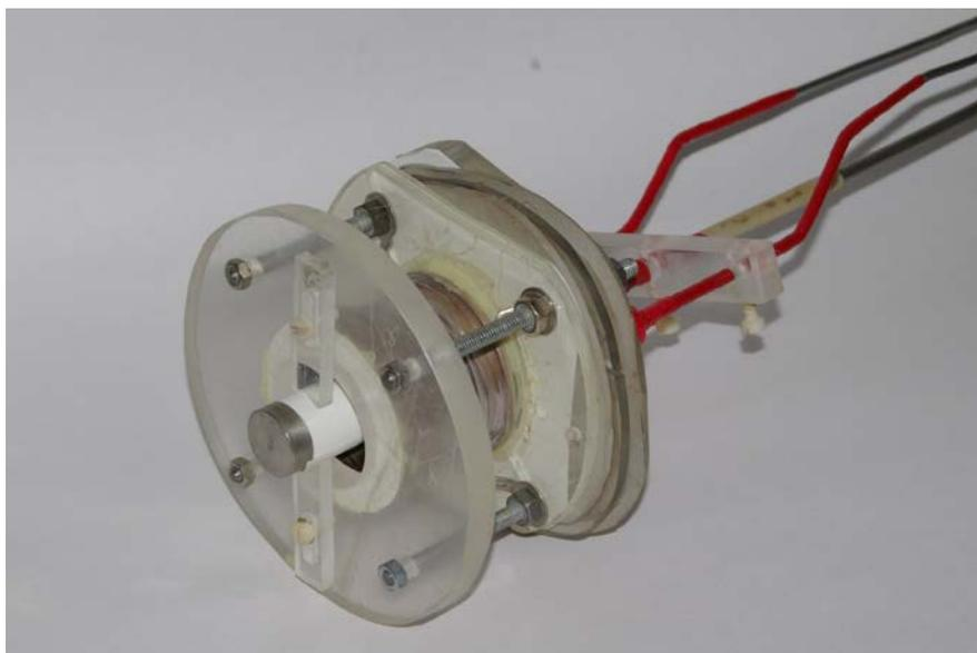
Рисунок 5.4 – Приспособление для формирования МДО покрытия на внутренней стенке стакана подшипников 38.07.00031
