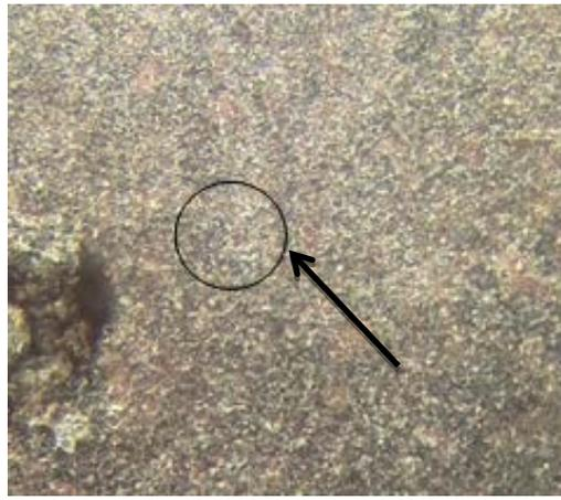
Рисунок 4.51 – Пятно повреждения МДО покрытия при  $F_n = 150\text{Н}$  и  $D = 6\text{мкм}$
