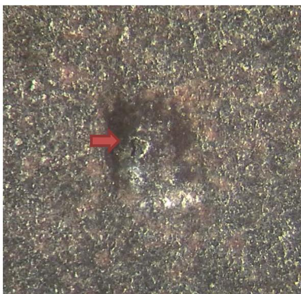
Рисунок 4.53 – Пятно повреждения МДО покрытия при  $F_n = 150\text{Н}$  и  $D = 200\text{мкм}$
