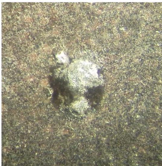
Рисунок 4.54 – Пятно повреждения МДО покрытия при  $F_n = 150$ Н и  $D = 300$ ммк
