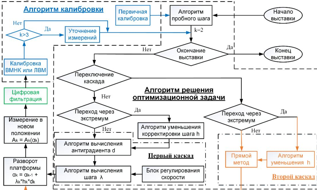
Рисунок 3 – Блок-схема алгоритма выставки
