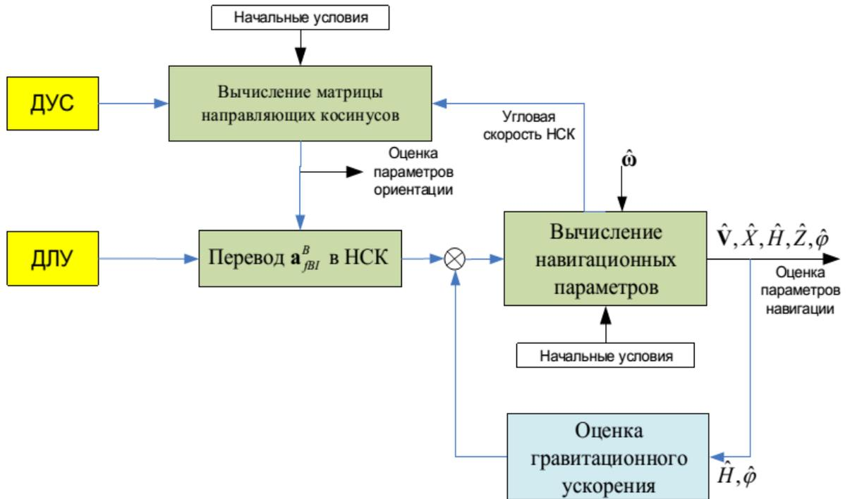
Рис.1.6. Общая схема работы БИНС[32]
