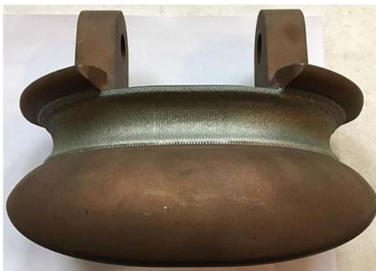
Рисунок 7 – Башмак тормозного устройства после широкополосной лазерной газопорошковой наплавки
