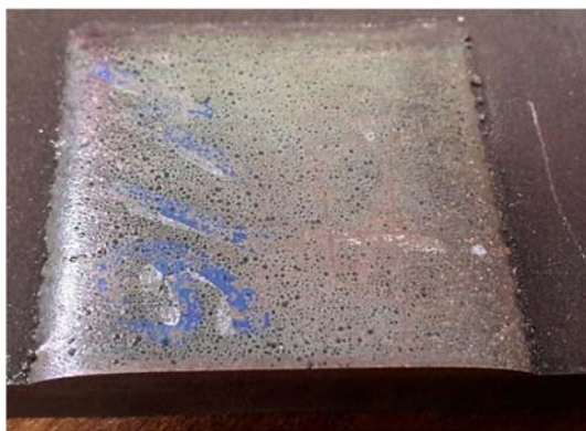
Рисунок 4 – Внешний вид наплавленных слоев Х25Н10В8 на сталь ВНЛ-3 при широкополосной наплавке с добавлением 7 масс.% буры в наплавляемый порошок
