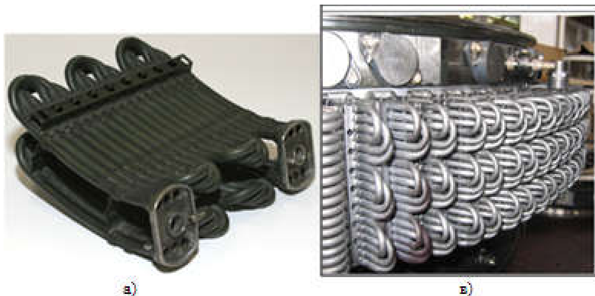
Рис. 1.3 - Отдельный модуль ВВТ (а) и его полная секция (в), состоящая из 64-х модулей, равномерно расположенных на корпусе газогенератора ТВД
