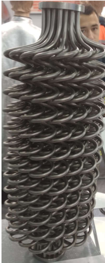
Рис. 5.3 - Конфигурация ВВТ ТРДД ПС-90 А с цилиндрическими трубками винтовой формы, диаметр наружной поверхности 6,0 мм, их толщина 0,8мм.
