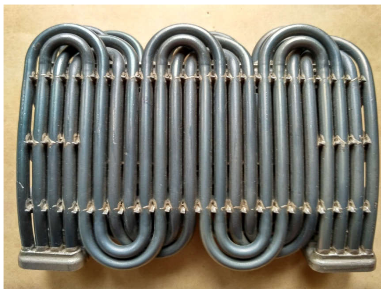
Рис. 5.12 – Двухрядный, четырёх трубчатый, шести перекрёстный ВВТ
