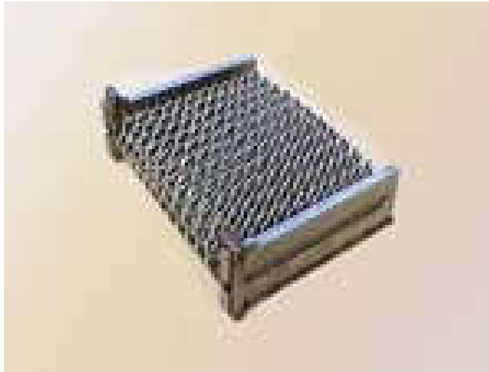
Рис. 5.3 - Конфигурация ВВТ ТРДД ПС-90 А с цилиндрическими трубками винтовой формы, диаметр наружной поверхности 6,0 мм, их толщина 0,8мм.
