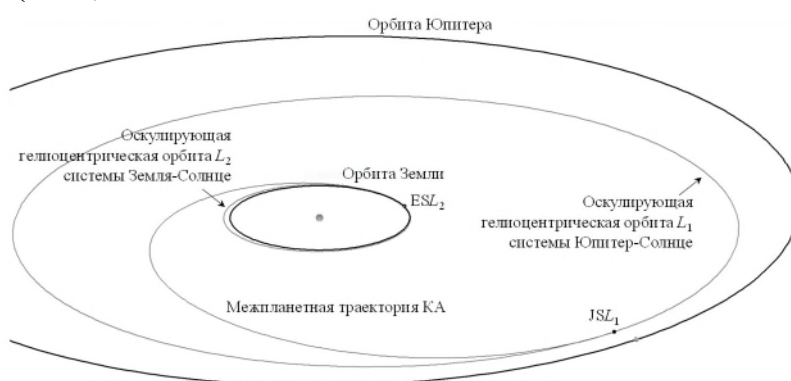
Рисунок 11. Схема межпланетного перелета КА с ЭРДУ между точками либрации ESL_2 и JSL_1 .
