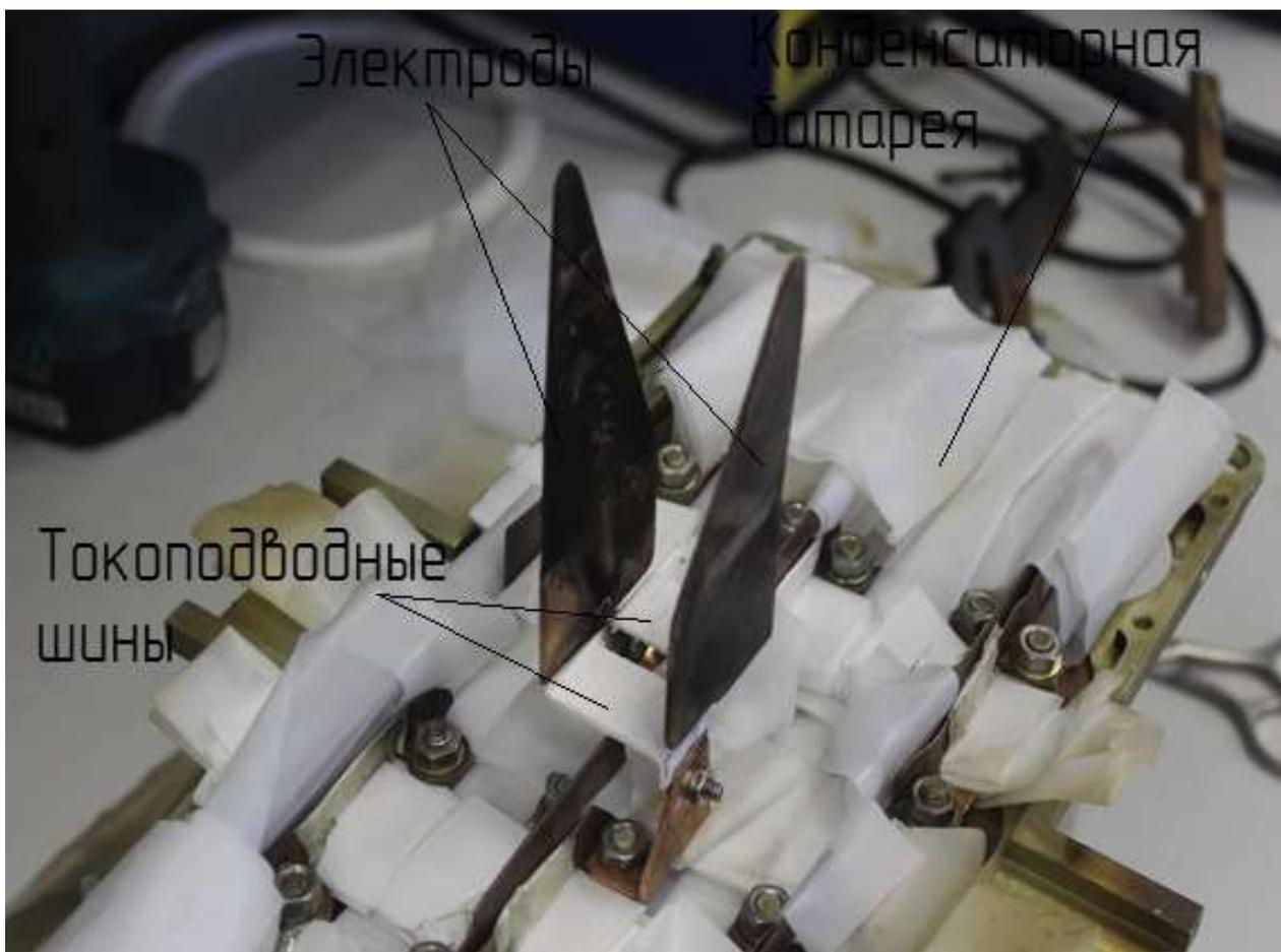
Рисунок 46 – Внешний вид лабораторной модели АИПД с двумя шинами обратного токоподвода
