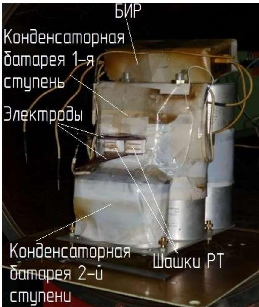
Рисунок 119 – Лабораторная модель АИПД с двухступенчатой системой ускорения
