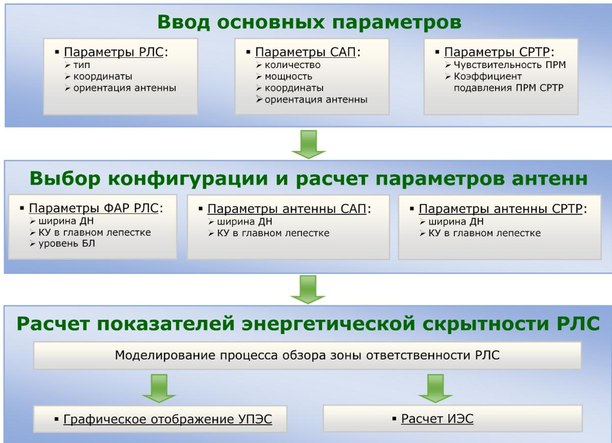
Рисунок 4.1 - Структурная схема модели
