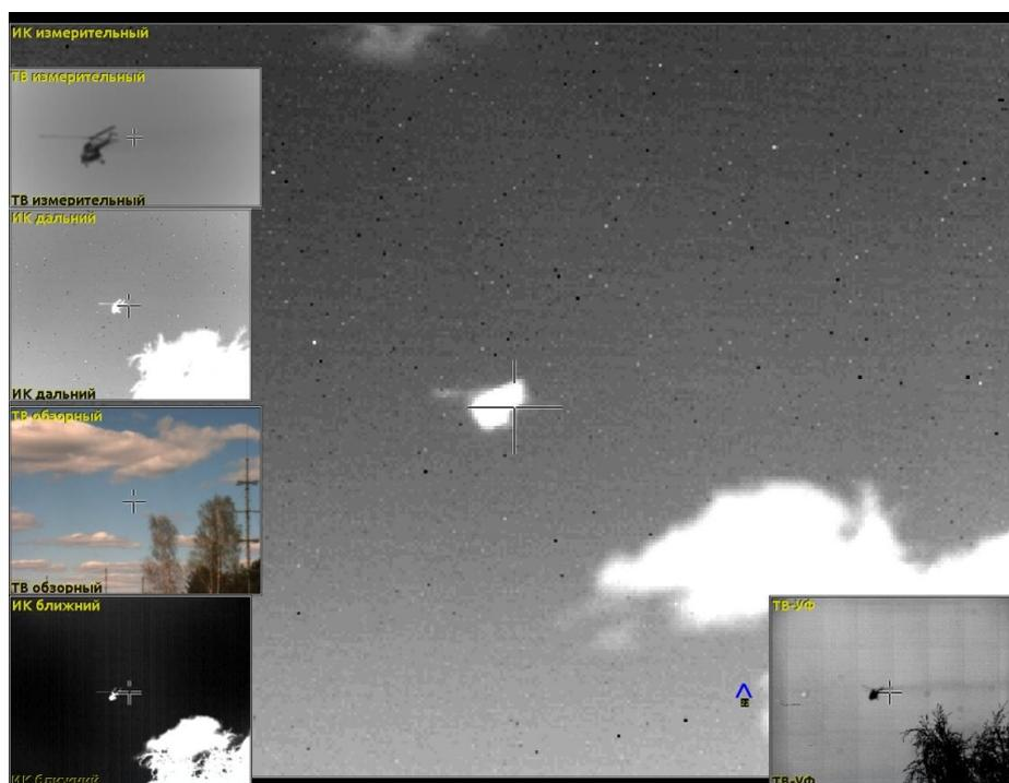
Рисунок 5 – Многоканальное изображение вертолета во время проведения измерений
