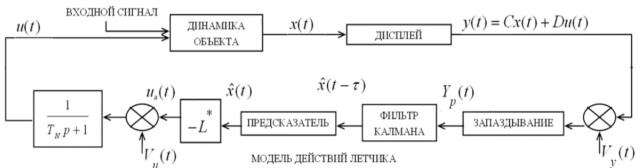
Рисунок 3.3. – Структурная схема оптимальной модели управляющих действий летчика [21]
