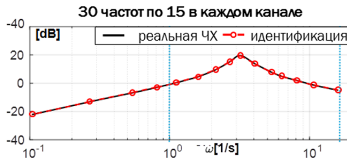
Рисунок 2.6. – Пример идентификации амплитудной частотной характеристики
