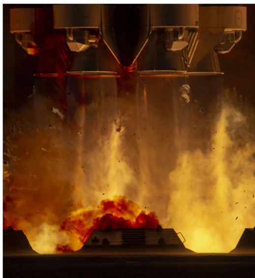
Рисунок 1 – Воздействие газовой струи от двигательной установки на наземное оборудование при старте ракеты космического назначения
