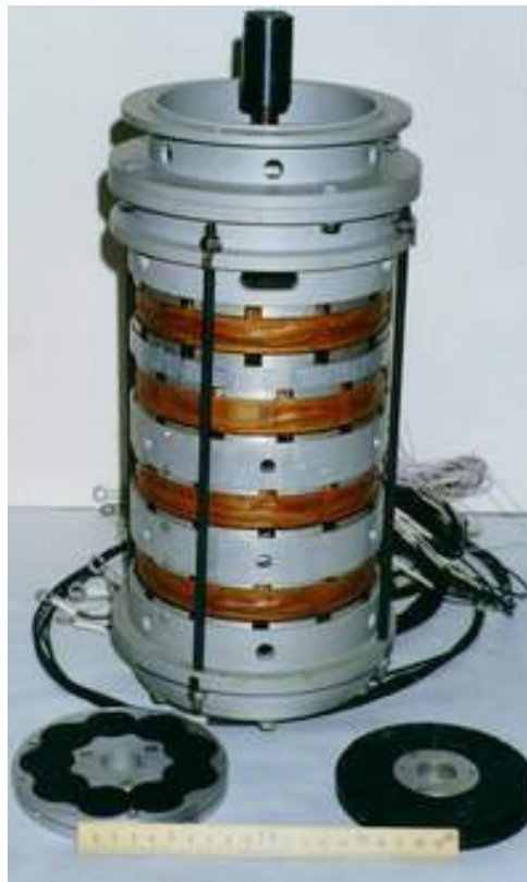
Рисунок 1.9. Многодисковый гистерезисный ВТСП-двигатель (МАИ, РФ)
