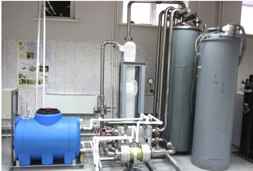
Рисунок 1.16. Общий вид криорефрижератора КР 001 с холодопроизводительностью до 2,5 кВт
