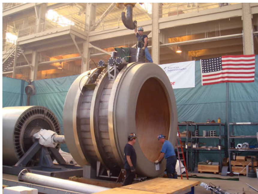
Рисунок 1.5. Судовой ВТСП-электродвигатель мощностью 36,5 МВт («American Superconductors» и «Northrup Grumman», США)
