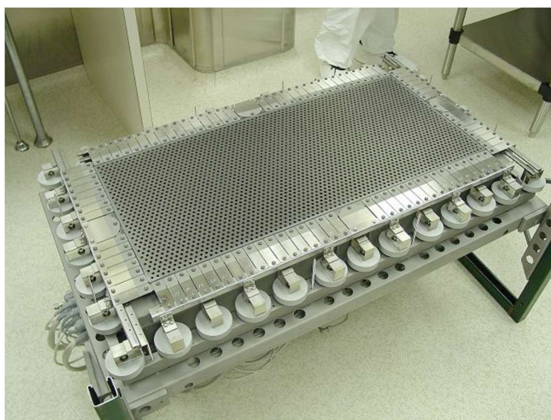
Рисунок 21 - Демпфирующие системы ИОС двигателя HiPER [55].
