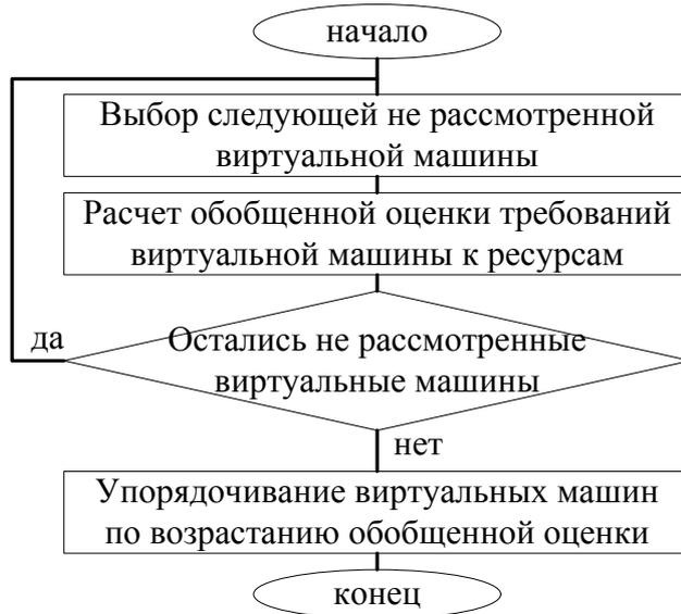
Рисунок 2.4. Блок-схема алгоритма определения порядка размещения виртуальных машин
