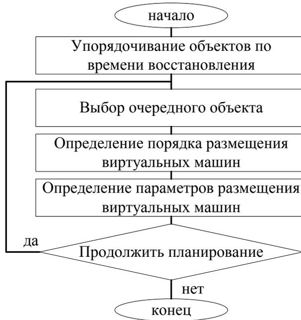
Рисунок 2.3. Блок-схема алгоритма планирования процессов восстановления
