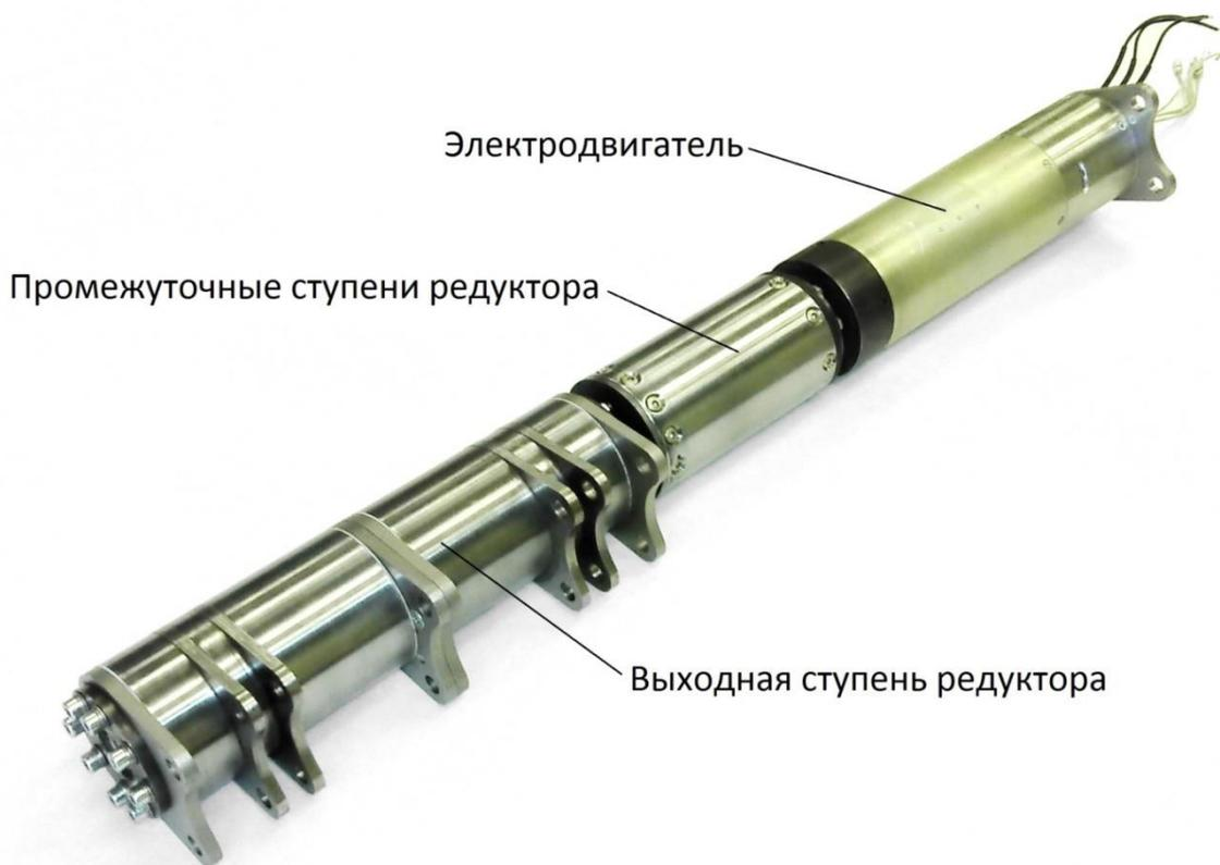
Рисунок 4.5. Привод створок грузового отсека.
