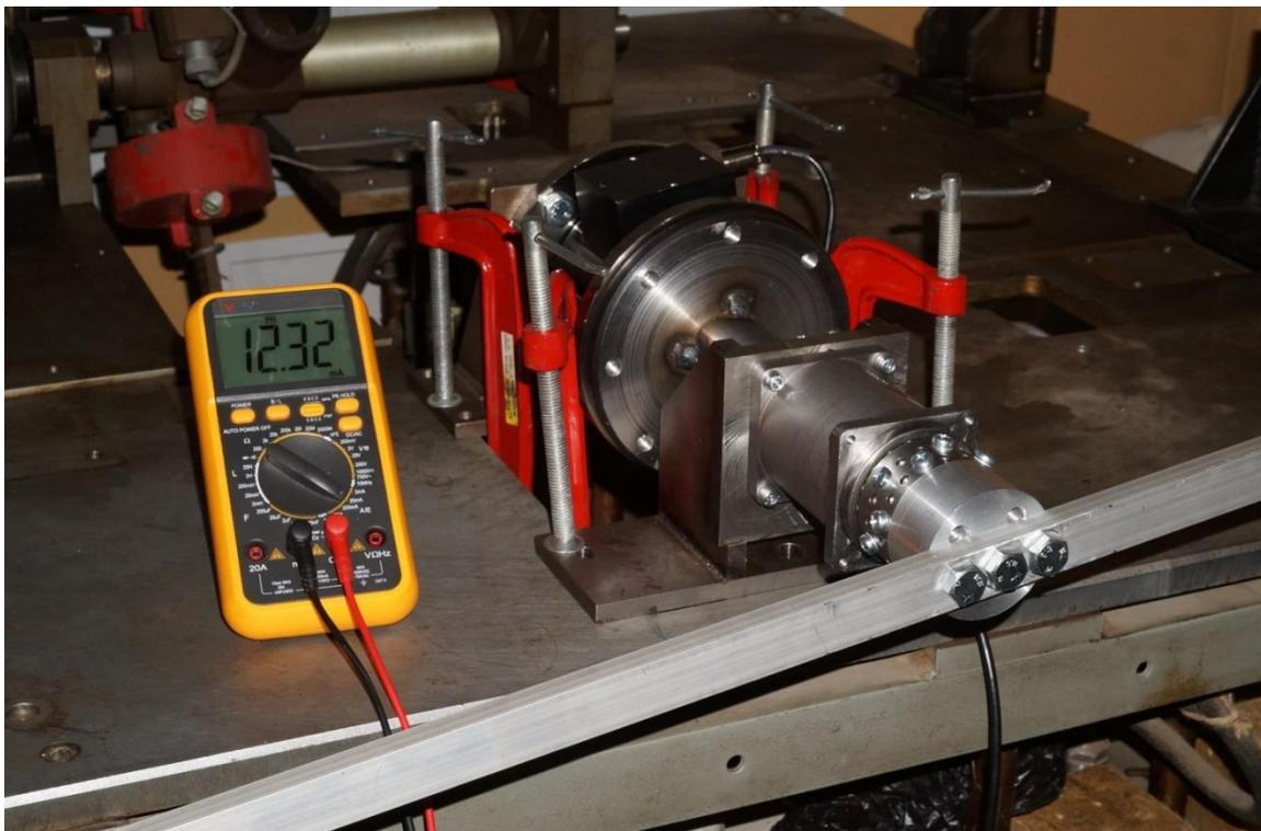
Рисунок 4.7. Испытательный стенд для снятия нагрузочной характеристики и характеристики передаваемого момента выходной ступени редуктора.
