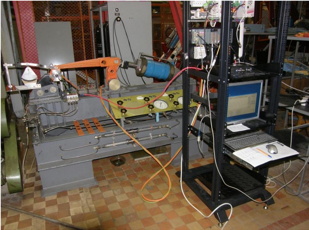
Рисунок 4.6. Фотографии испытательного стенда привода с пневматическим нагрузателем.
