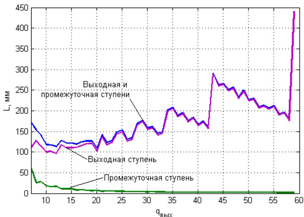
Рисунок 1.38. Зависимость потребных рабочих длин двухступенчатого редуктора от передаточного числа выходной ступени.
