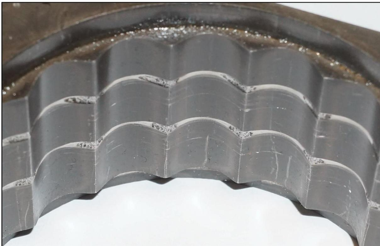
Рисунок 2.1. Дорожки от шариков в жёстком колесе волновой передачи.
