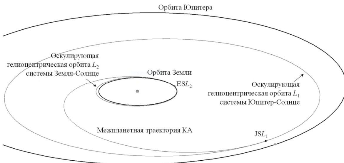
Рисунок 6.1. Схема межпланетного перелета КА с малой тягой между точками либрации ESL_2 и JSL_1 .
