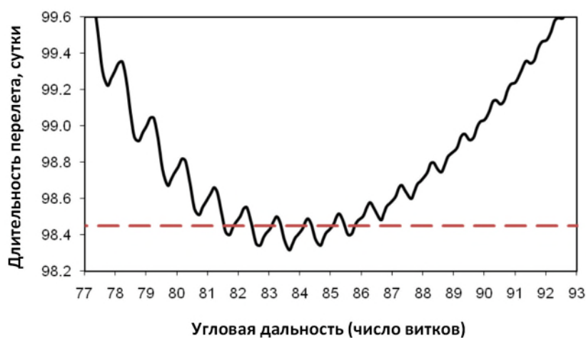
Рисунок 1.1.1 – Типичная зависимость минимальной длительности перелета от его угловой дальности
