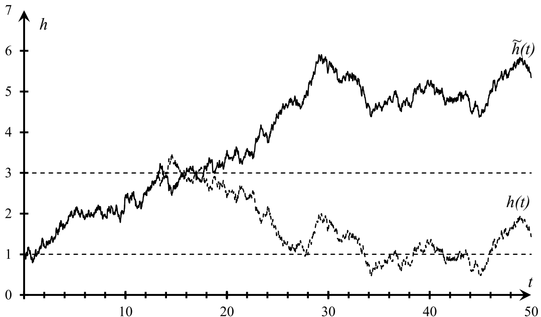
Рис. 4.1. Изменение высоты h(t) аэростата и эквивалентная траектория процесса \tilde{h}(t) .
