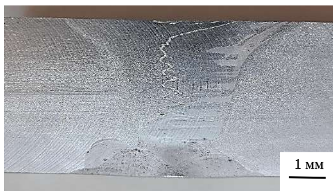
Рисунок 3.12 – Макроструктура сварного соединения листов сплава 1565ЧМ после различных вариантов устранения дефекта в виде несплавления в корневой части шва:
