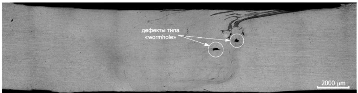
Рисунок 4.14 – Сочетание дефекта в виде линии стыка и дефекта типа «несплошность»
