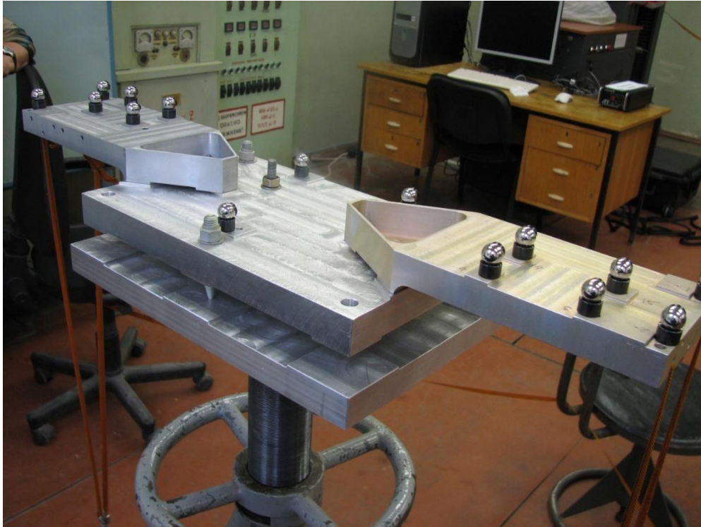
Рис. 4.5 Установка для проведения сравнительных испытаний моделей платформ из сплавов АМГ6 и САС-1-50
