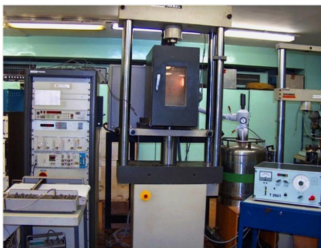
Рис. 5.2 Испытательная машина «Schenck-Trebel» RMC-100 с термостатом «VEB TIR Fritz Heckert».
