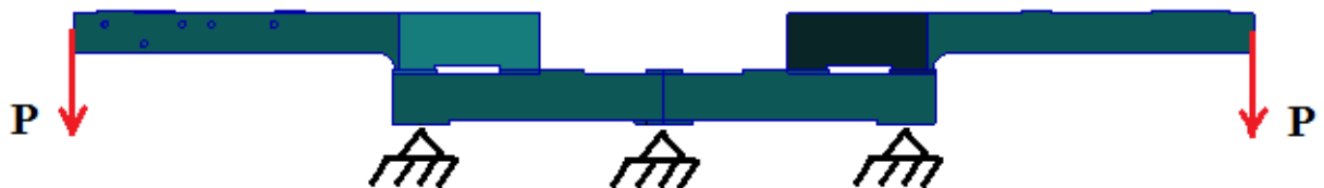
Рис. 4.8 Схема приложения нагрузки при стендовых испытаниях платформ сплавов АМгб и САС-1-50
