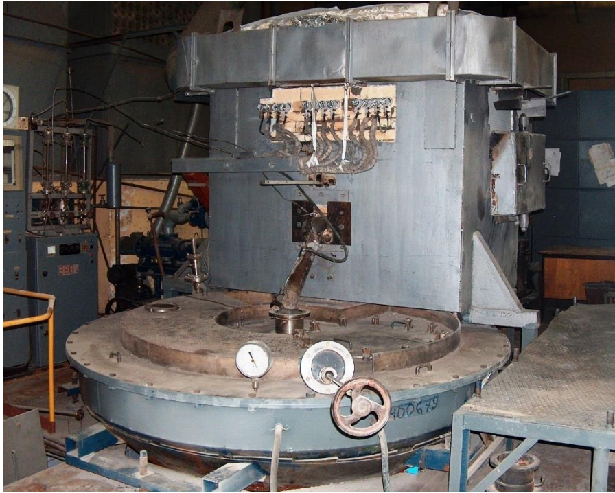
Рис. 2.2 Установка для получения гранул центробежным разбрызгиванием расплава
