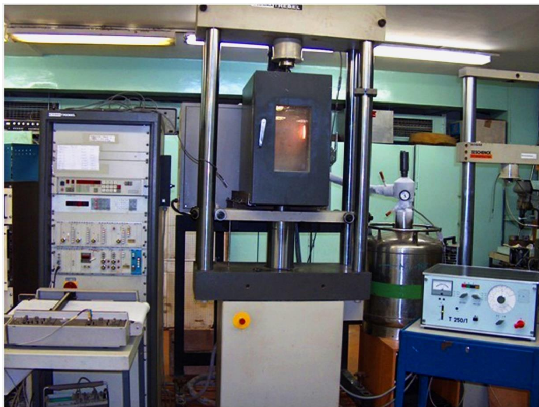
Рис. 2.7 Испытательная машина «Schenck-Trebel» RMC-100 с термостатом «VEB TIR Fritz Heckert».
