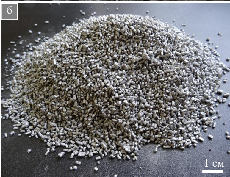
Рис. 2. Внешний вид гранул порошка, полученного после механической обработки ( \tau_0 = 180 минут) (а), полученного методом «омыления стеарина» (б).
