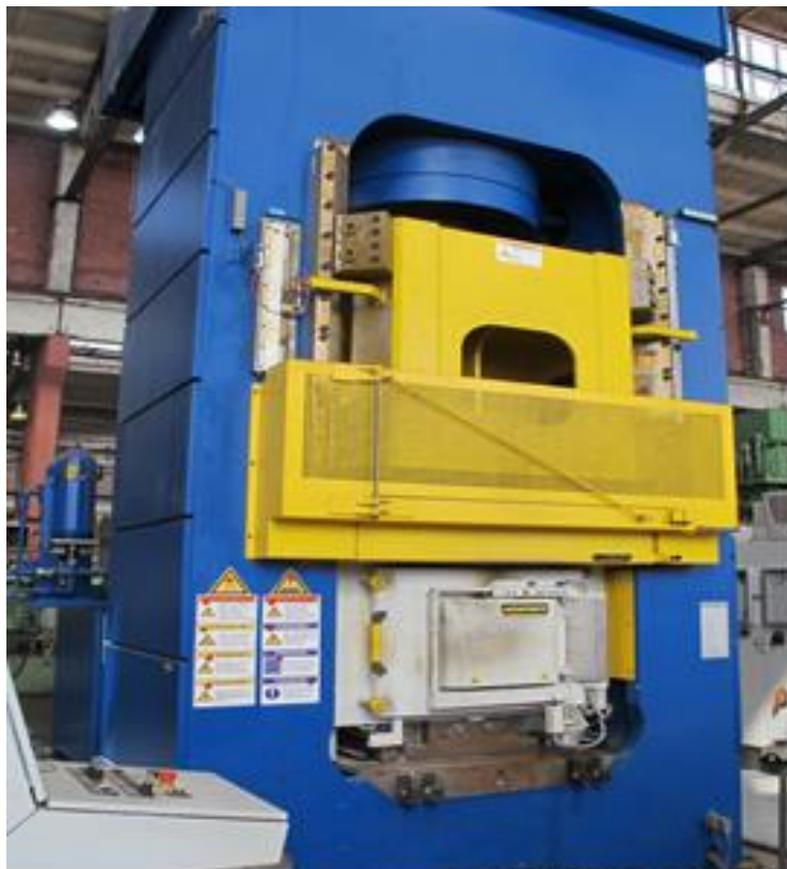
Рисунок 3.14 - Пресс для изотермической штамповки
