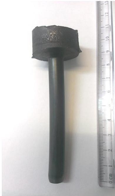
Рисунок 3.16 - Вид выдавленной заготовки
