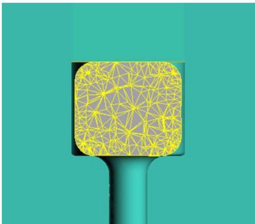
Рисунок 2.1 - Вид заготовки, разбитой на конечно элементную сетку
