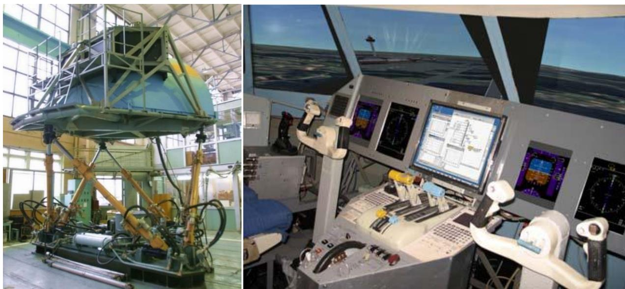
Рисунок 1.7 – Пилотажный стенд с подвижной кабиной ПСПК-102 ЦАГИ (общий вид стенда и интерьер кабины)
