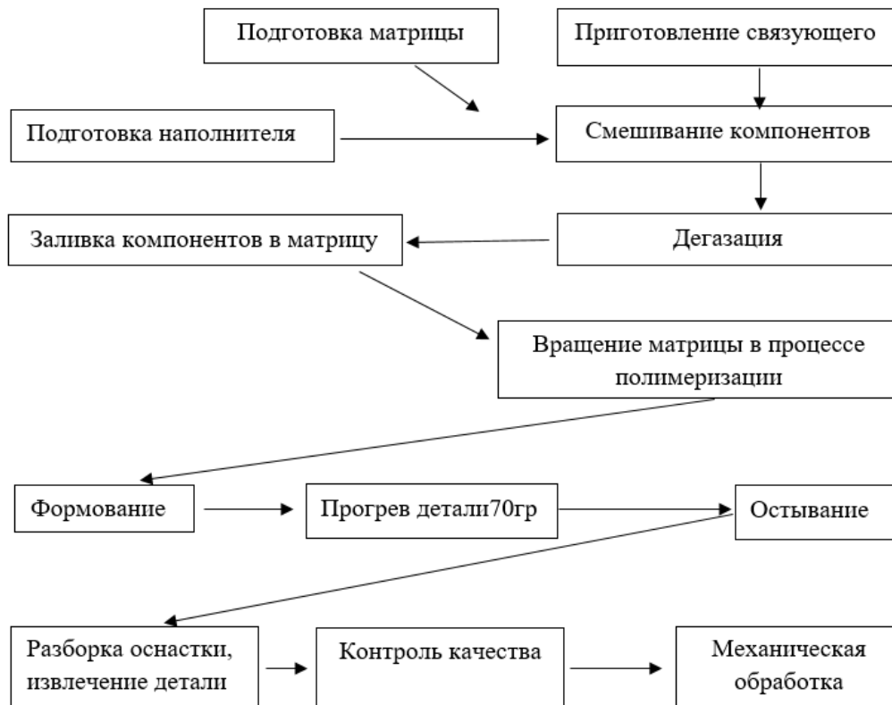
Рисунок 2.1. Технологическая схема изготовления композита
