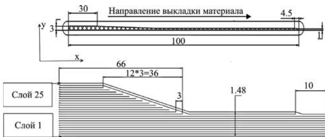
Рис. 1. Геометрические параметры (мм) конструктивно подобных реальным гибких элементов первого типа
