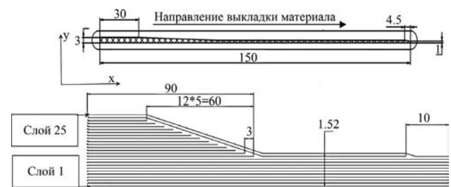
Рис. 2. Геометрические параметры (мм) конструктивно подобных реальным гибких элементов второго типа
