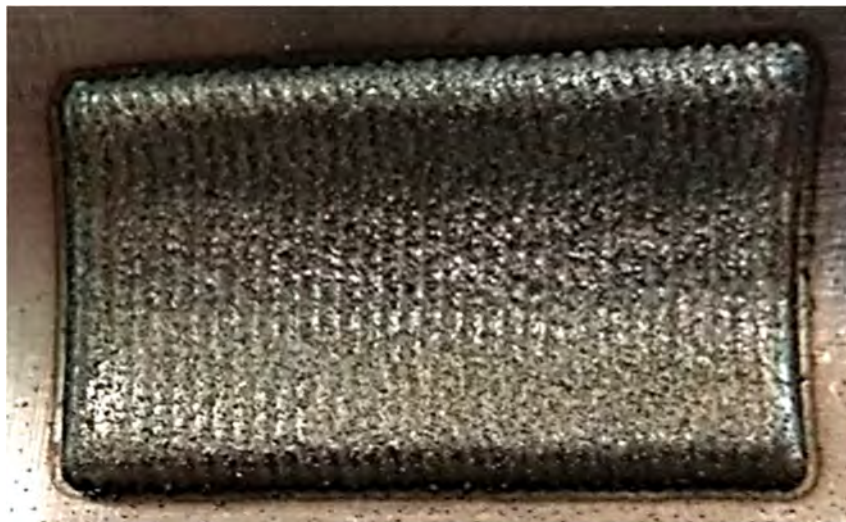
Рисунок 4.6 – Внешний вид наплавленной поверхности на поверхности образца из стали 08X14H5M2ДЛ (ВНЛ-3)
