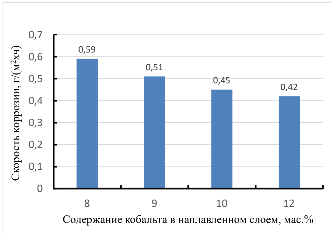
Рисунок 4.26 – Зависимость скорости межкристаллитной коррозии покрытия от содержания кобальта в наплавленном слое
