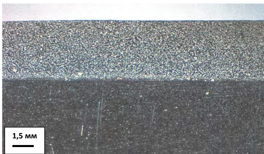
Рисунок 4.7 – Макроструктура наплавленного слоя на стали ВНЛ-3 сплавом X25H10B8 в поперечном (а) и продольном (б) сечениях
