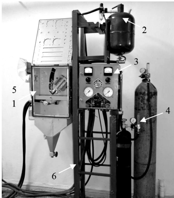
Рисунок 4.32 – Установка для испытаний на газоабразивное изнашивание [108]:
