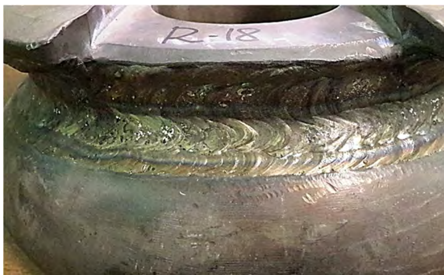
Рисунок 1.6 – Башмак с наплавленным износостойким слоем
