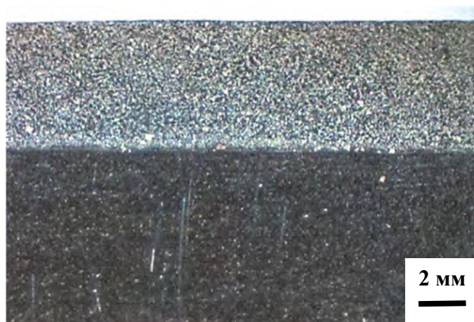
Рисунок 3.14 – Макроструктура границы наплавленного слоя и основы (х6)
