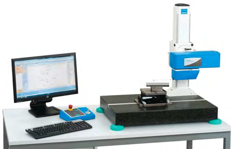
Рисунок 2.16 – Профилометр HOMMEL-ETAMICT8000 для определения шероховатости поверхности и профиля следов износа
