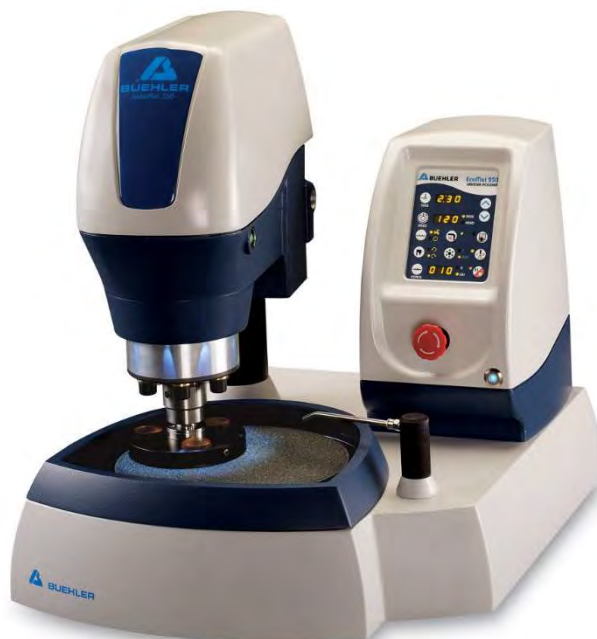
Рисунок 2.9 – Автоматический шлифовальный станок BUEHLER comet-250
