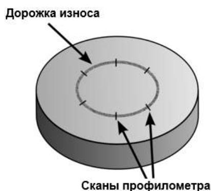
Рисунок 2.18 – Схематическое изображение дорожки износа и измерения с помощью поверхностного профилометра (сканы)
