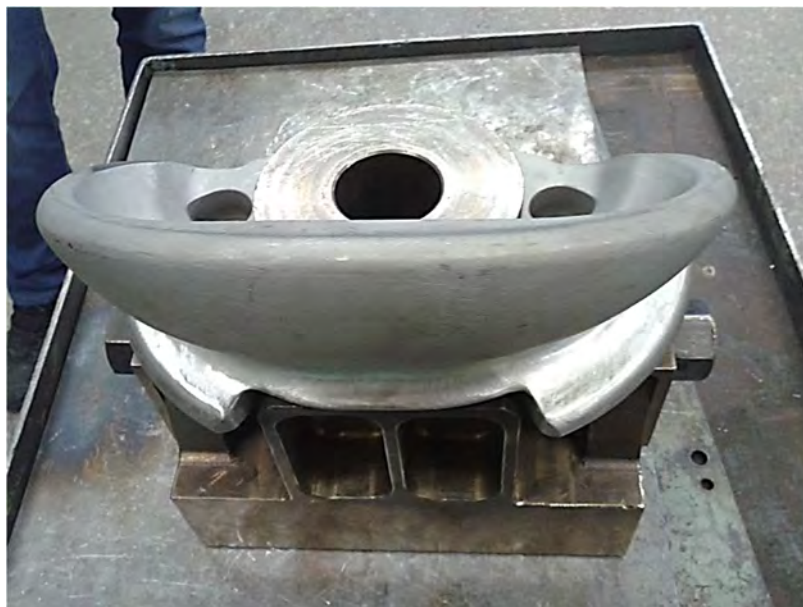
Рисунок 5.4 – Фиксация башмака по проушинам перед ручной аргонодуговой наплавкой
