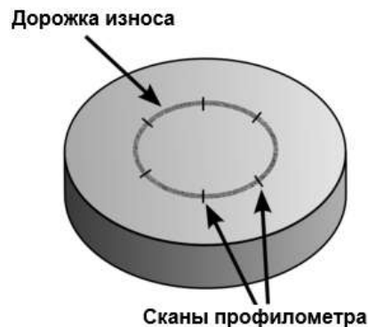
Рисунок 3.15 – Схематическое изображение дорожки износа и измерения с помощью поверхностного профилометра (сканы)
