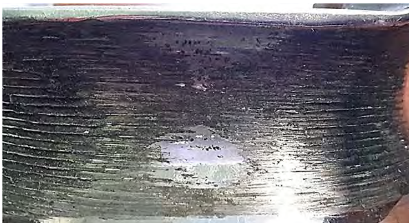
Рисунок 1.2 – Повреждение башмака посадочного устройства без достаточного защитного покрытия в процессе эксплуатации (после одноразового применения)
