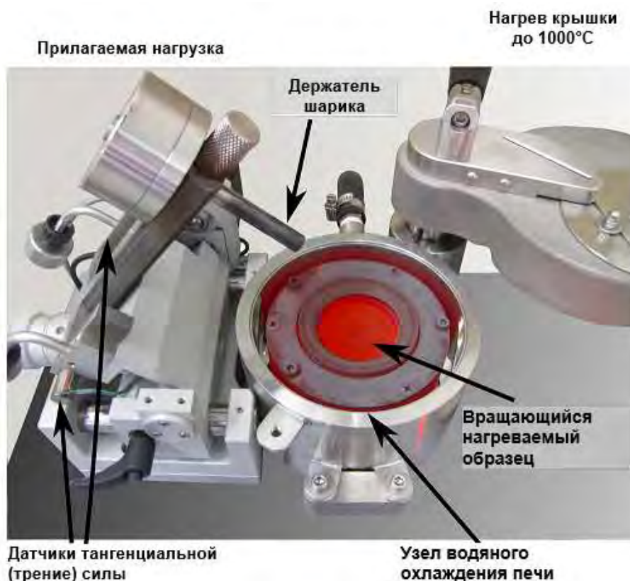
Рисунок 2.17 – Штифтодисковый трибометр ТНТ1000 с нагреваемыми образцами, представляющий основные компоненты для измерения приложенной силы и тангенциальной силы. Верхний нагреватель используется для быстрого получения максимальной температуры 1000 °С
