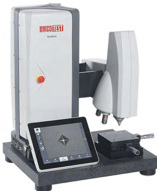
Рисунок 2.12 – Внешний вид автоматического микротвердомера DuraScan 20
