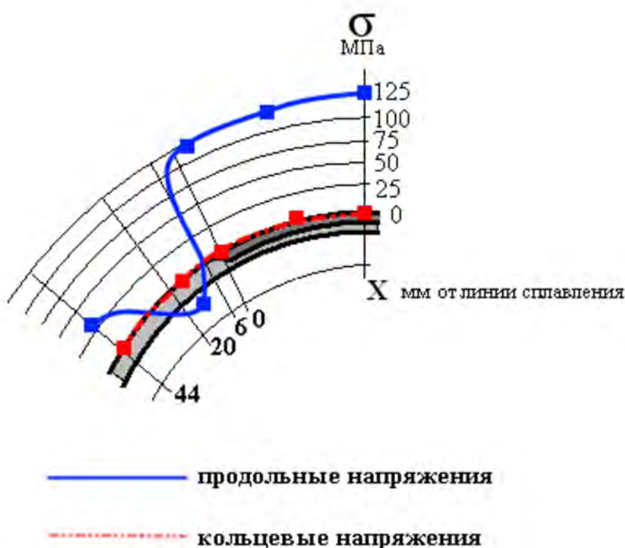
Рисунок 3.9 – Эпюра остаточных напряжений в наплавленном слое поперек оси наплавленного валика
