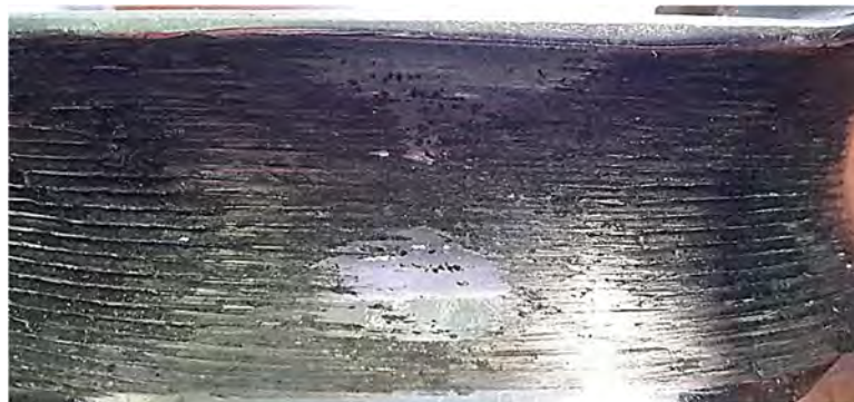
Рисунок 5.7 – Рабочая поверхность башмака в зоне наплавки после 60 циклов нагружения (ручная аргонодуговая наплавка)
