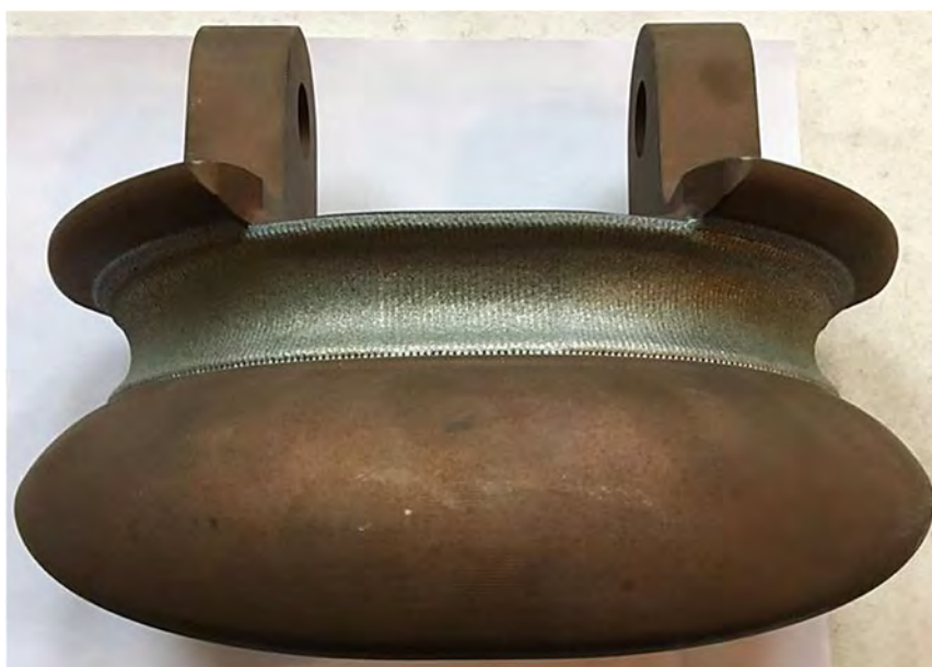
Рисунок 5.6 – Башмак после широкополосной лазерной газопорошковой наплавки
