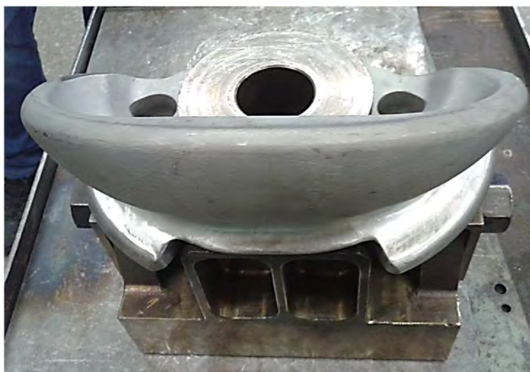
Рисунок 1.5 – Башмак в сварочном приспособлении, подготовленный к наплавке
