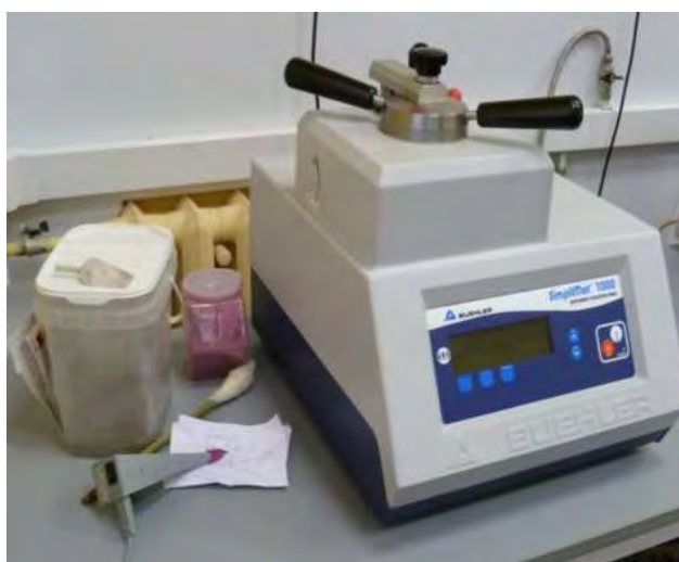
Рисунок 2.8 – Автоматический пресс для запрессовки образцов SimpliMet-1000
