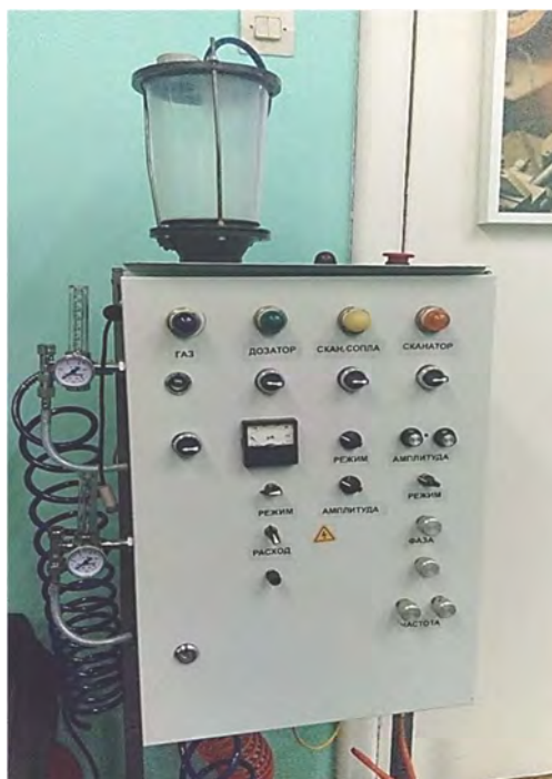
Рисунок 2.5 – Питатель для подачи порошка в наплавочную головку
