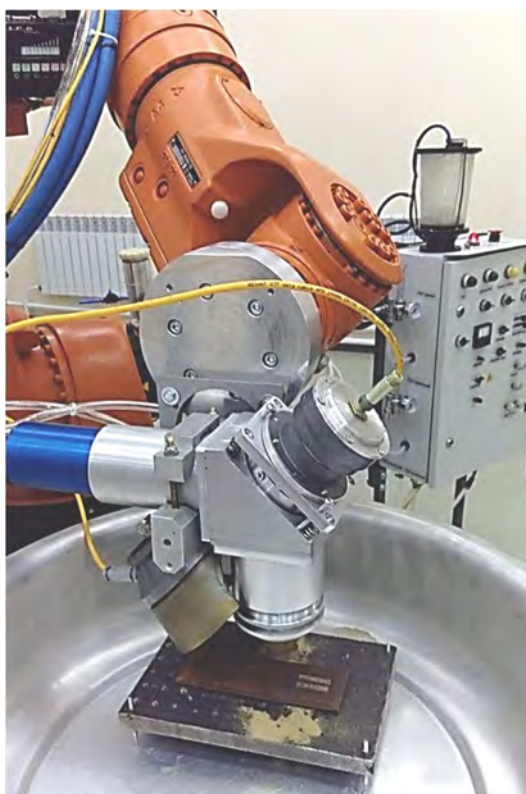
Рисунок 2.2 – Промышленный робот ABBIRB 2400 с технологической наплавочной головкой
