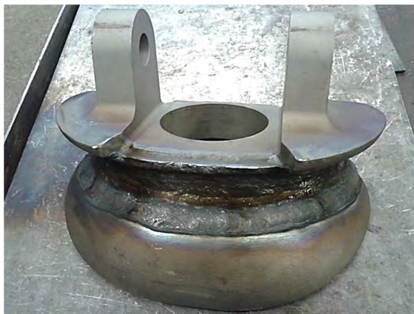
Рисунок 5.5 – Башмак после ручной аргодуговой наплавки
