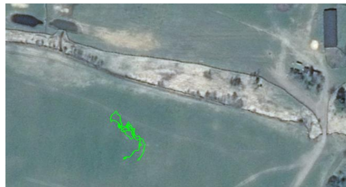
Рисунок 41– Результаты обработки натурных данных №2: а) – Эволюция ошибки определения высоты БВС вертолетного типа; б) – Фрагмент полета опытного образца в ходе проведения летных испытаний; в) – Траектория полета БВС вертолетного типа
