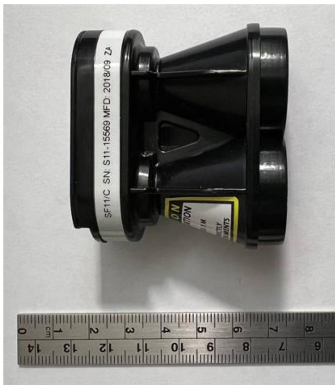
Рисунок 36– Внешний вид ЛВ Lightware Sf11/c
