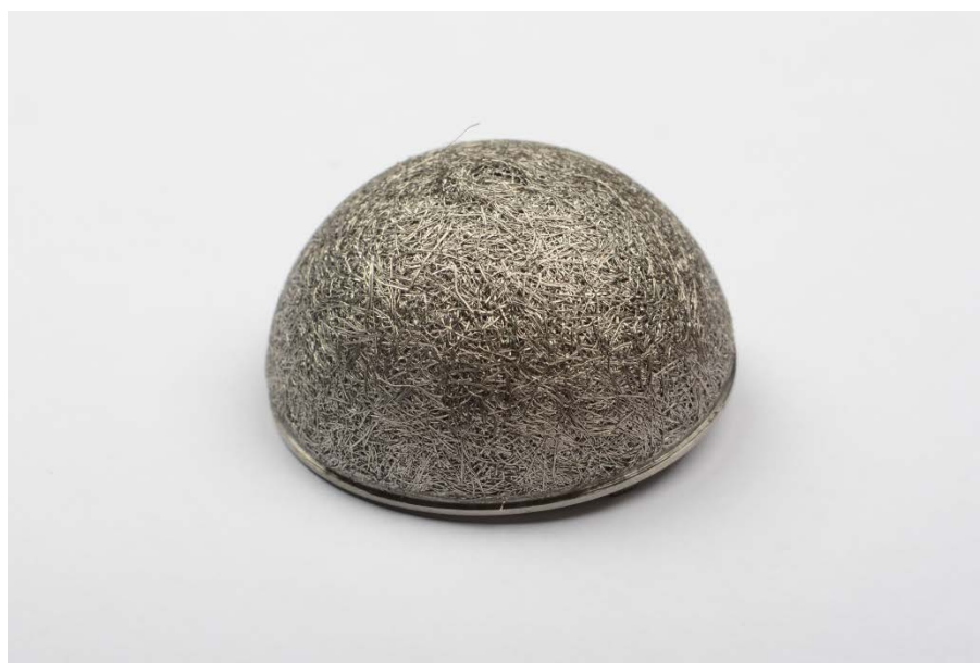
Рисунок 5.8 - Макетный образец вертлужного компонента эндопротеза тазобедренного сустава из сплава ВТ6 с остеоинтегрирующим покрытием из волокон сплава ВТ1-0
