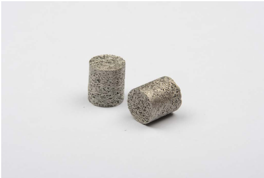
Рисунок 4.19 Макеты протезов тел позвонков, изготовленные из волокон технического титана
