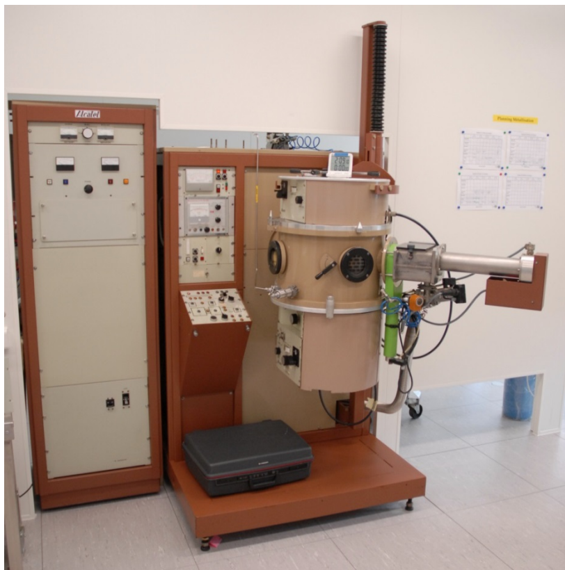
Рисунок 1.3 - Установка для вакуумного напыления.
