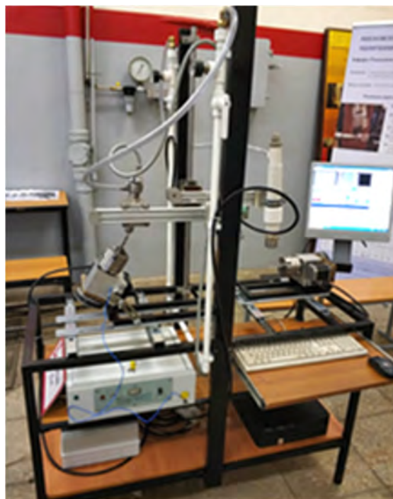
Рисунок 7 - Оборудование для формирования дискретного оксидного слоя, оснащенное механизмом крепления деталей
