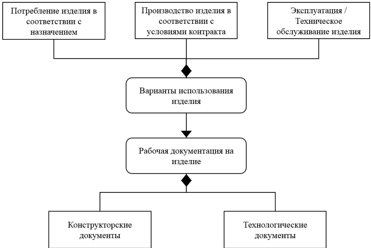
Рисунок 2.2.4 – Семантическая сеть суперкласса «Рабочая Документация»
