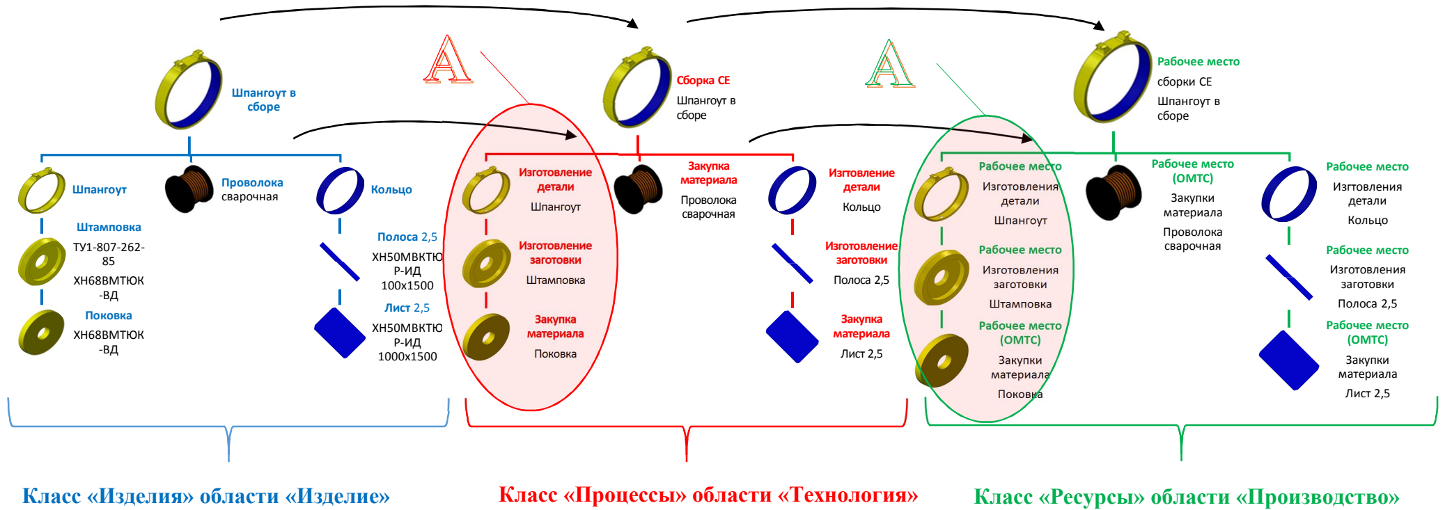
Рисунок 4.3.9 – Механизм наследования структур, описывающих изделия с установлением связей между объектами и между связями объектов. Увеличенный фрагмент А детализирован на рисунке 4.3.10
