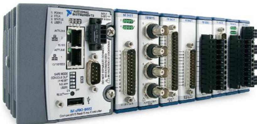
Рис.11 Контроллер NI CompactRIO.
