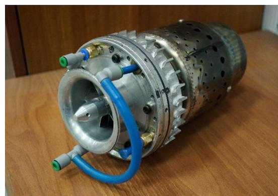
Рис. 2. Двигатель с тягой 167Н.
