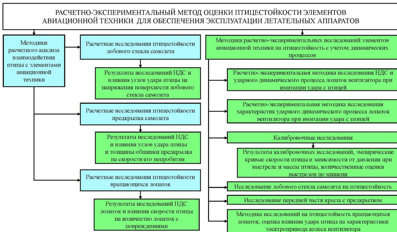
**Рисунок 1** – Блок-схема расчетно-экспериментального метода оценки птицестойкости элементов авиационной техники для обеспечения эксплуатации летательных аппаратов
