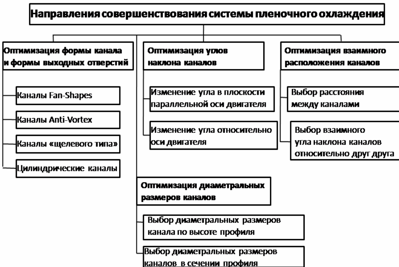
Рис.15. Основные направления конструктивного совершенствования системы плёночного охлаждения лопаток современных и перспективных турбин ВРД.
