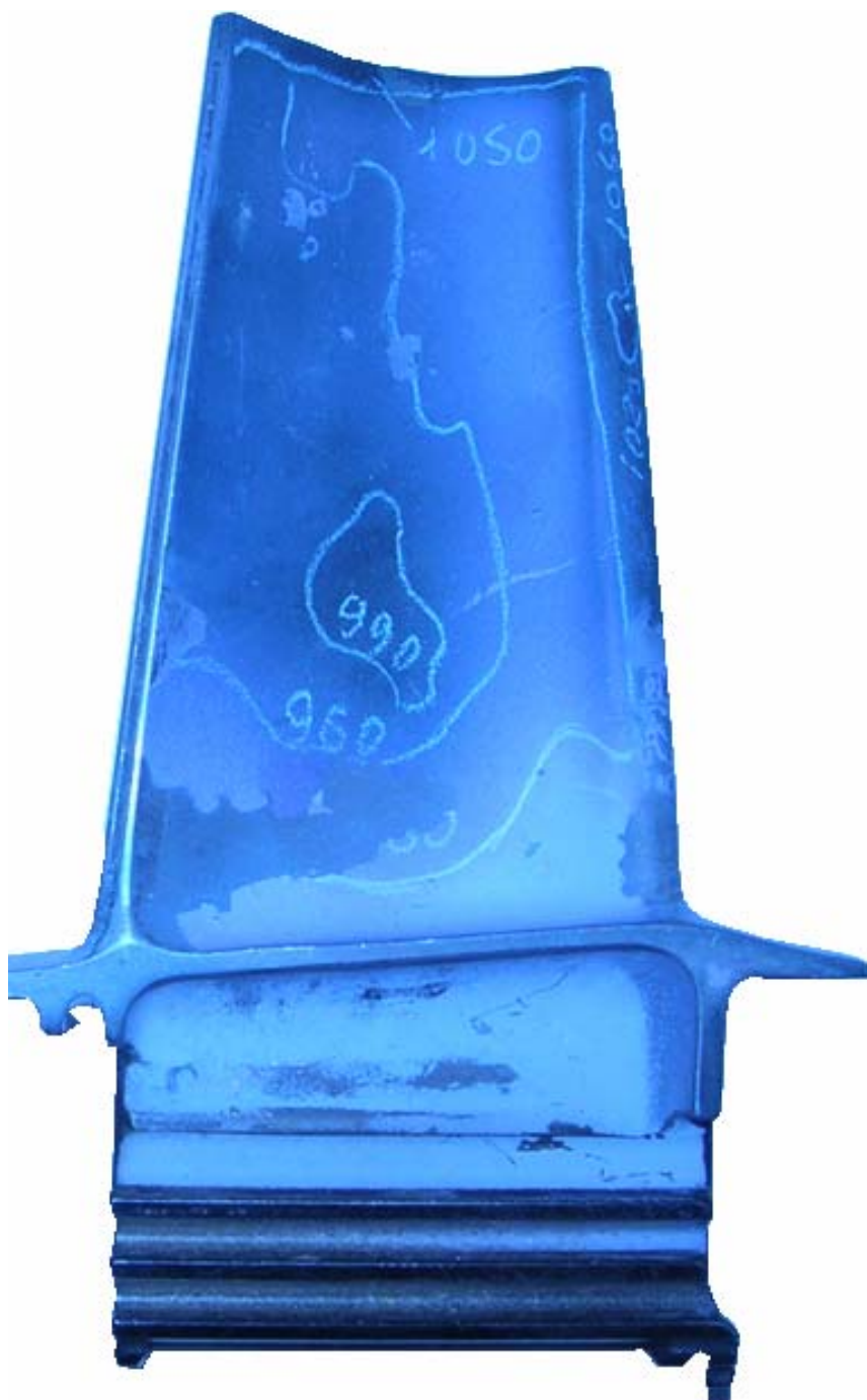
Рис.6. Распределение температур материала лопатки с конвективным охлаждением на вогнутой стороне профильной поверхности пера, полученное с помощью термокрасок Роллс-Ройс.
