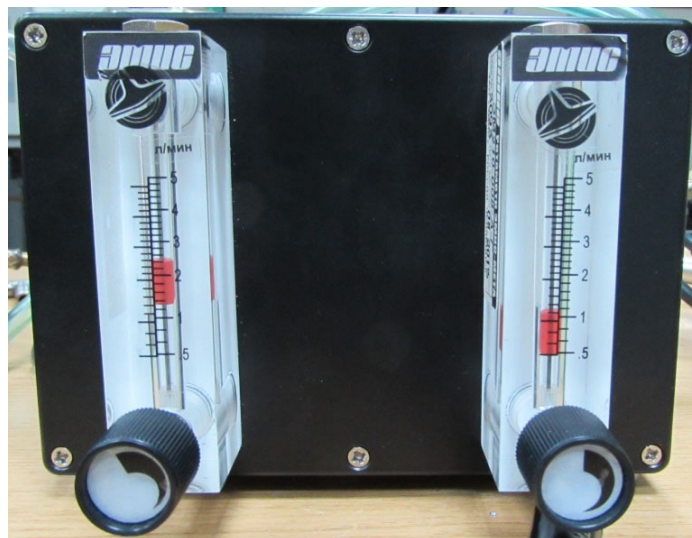
Рисунок 2.5. Смеситель газов с пластиковыми ротаметрами ЭМИС-мета 211
