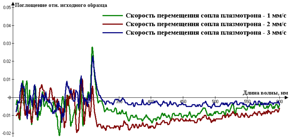
Рисунок 4.28. Спектры поглощения фторуглеродных покрытий в динамическом режиме нанесения при расстоянии плазматрон-подложка 15 мм, шаге обработки 3 мм, C_6H_{12} – 2,5%
