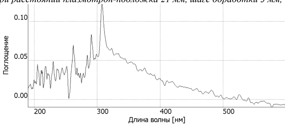
Рисунок 4.30. Спектр поглощения фторуглеродного покрытия, полученного вакуумным методом осаждения из газовой фазы
