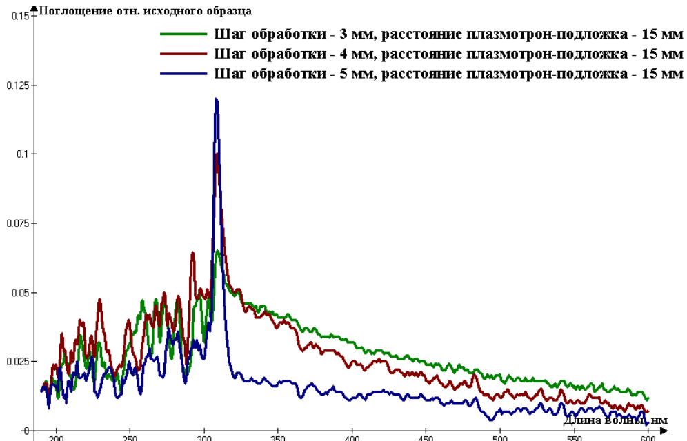
Рисунок 4.33. Спектры поглощения фторуглеродных покрытий в динамическом режиме нанесения при расстоянии плазмотрон-подложка – 15 мм, скорости перемещения сопла плазмотрона 2 мм/с, C_6H_{12} – 2,5%
