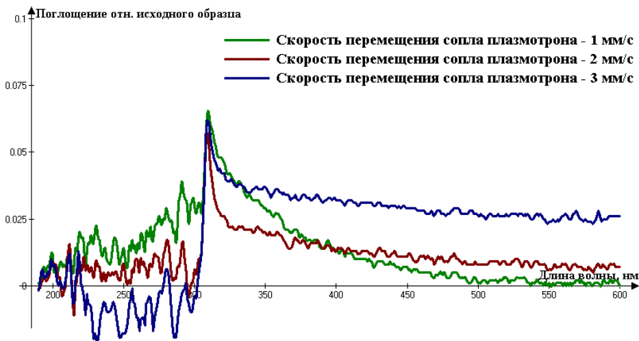
Рисунок 4.29. Спектры поглощения фторуглеродных покрытий в динамическом режиме нанесения при расстоянии плазматрон-подложка 21 мм, шаге обработки 3 мм, C_6H_{12} – 2,5%
