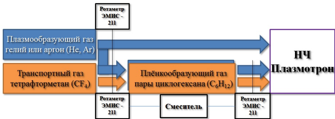
Рисунок 2.4. Блок-схема газового блока
