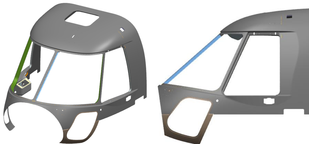
Рисунок 52 – Фонарь кабины пилотов из единовременно формируемого каркаса с устанавливаемыми конструктивными элементами
