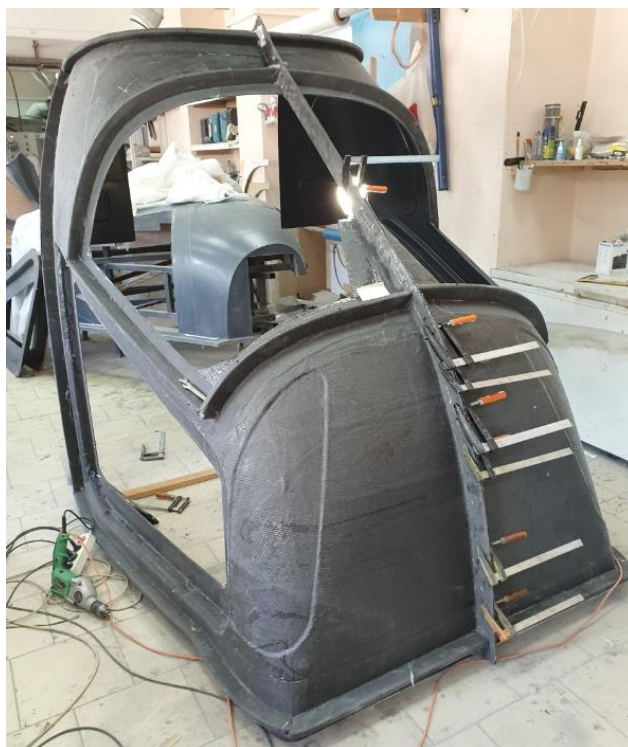
Рисунок 51 – Матрица фонаря кабины пилотов вертолета Ка-226Т
