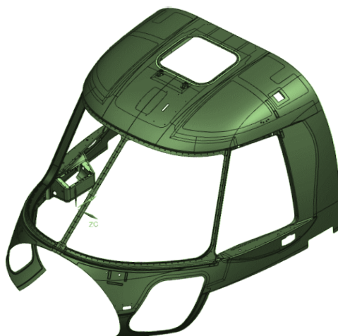
Рисунок 53 – Фонарь кабины пилотов из единовременно формуемого каркаса с устанавливаемыми конструктивными элементами
