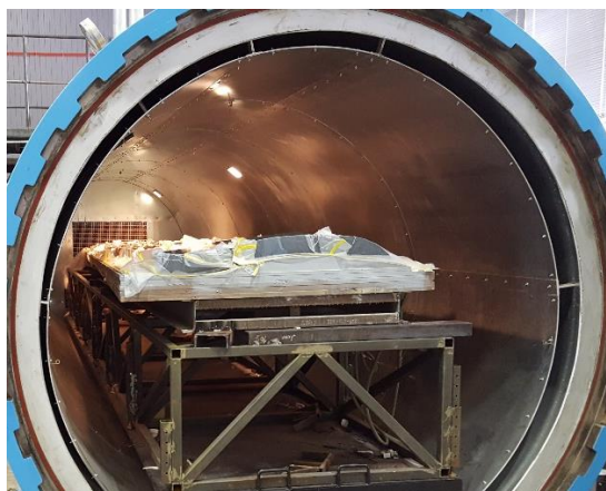
Рисунок 10 – Технологический пакет детали в автоклаве
