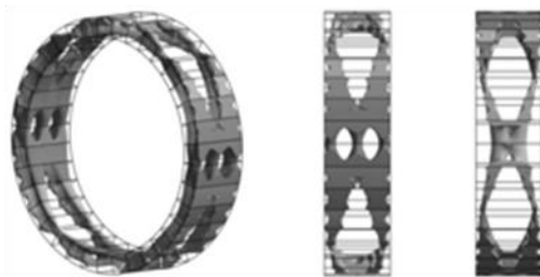
Результат топологической оптимизации
