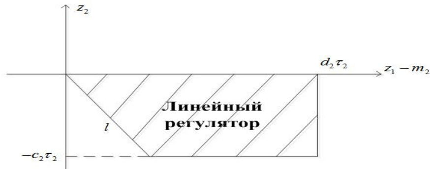
Рис. 5. Сокращенная область переключения релейного регулятора бокового движения на линейный в фазовой плоскости (z_1 - m_2, z_2)
