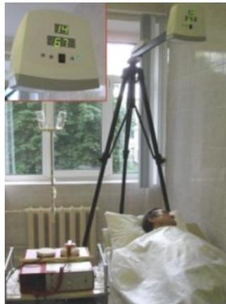
Рисунок 4.1. Радарный датчик регистрации дыхательной функции и пульса
