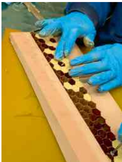
Рис. 6. Заполнение заготовки сотового заполнителя пастой
