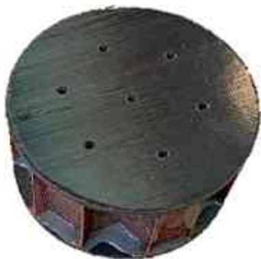
Рис. 10. Готовый образец разнорысотной ЗПК для проведения акустических испытаний на установке «Интерферометр-50»
