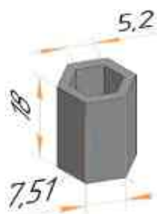
Рис. 2. Элемент вспомогательной оснастки — матрицы (ограничителя) высотой 18 мм
