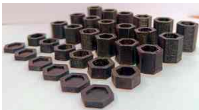
Рис. 3. Вспомогательная оснастка, изготовленная методом 3D-печати
