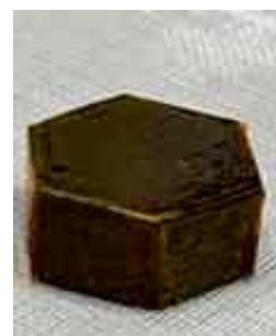
Рис. 4. Защита поверхности вспомогательной оснастки пленкой полиимидной
