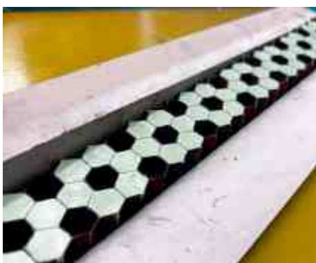
Рис. 7. Заготовка разновысотного заполнителя после полимеризации пасты
