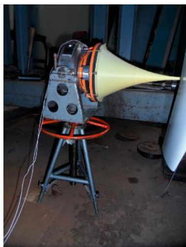
Рис. 3. Один из вариантов расположения УБВМК относительно объекта испытаний (лопасти винта) при проведении НЧИ
