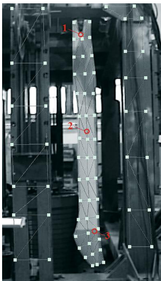
Рис. 2. Расположение точек возбуждения (○) и измерения (□) колебаний
