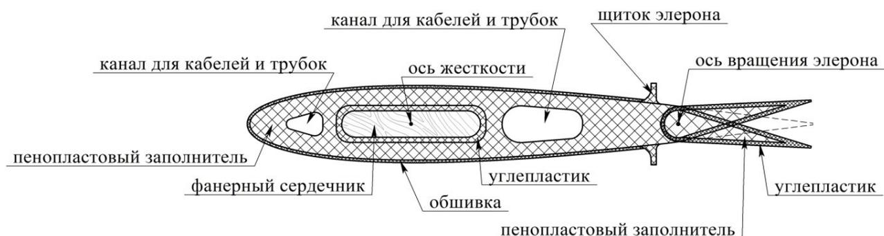
Рисунок 2.3.13 - Сечение крыла с установленным щитком/элероном
