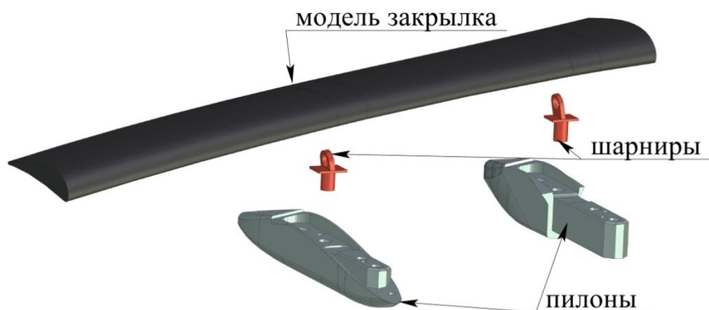
Рисунок 2.5.7 - Схема установке модели закрылка на модель консоли крыла
