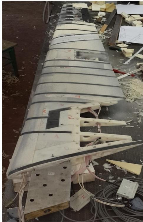
Рисунок 2.3.10 - ДДПМ с установленным пенопластом
