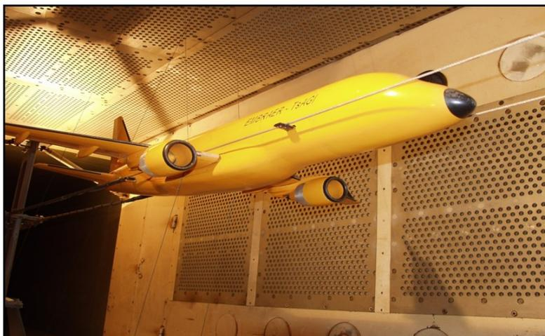
Рисунок 1.2.1 - ДПМ самолёта на «плавающей» подвеске в АДТ-128
