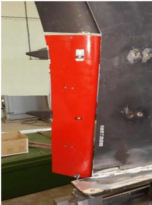
Рисунок 2.5.1 – ДДПМ внутренней секции закрылка установленная на аэродинамическую полумоделю
