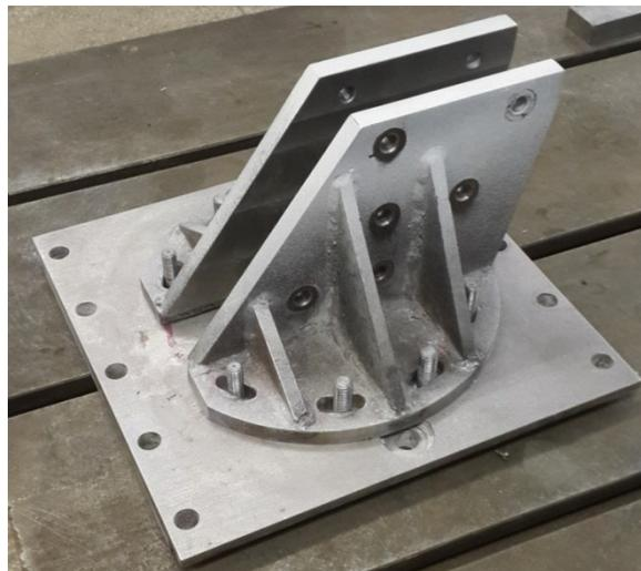
Рисунок 2.3.17 - Узел крепления модели в трубе
