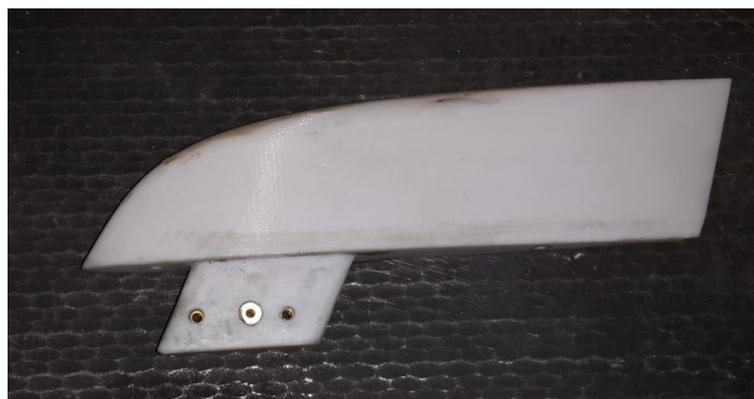
Рисунок 2.3.14 - Съемная законцовка ДДПМ
