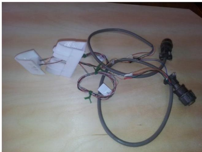
Рисунок 2.4.6 – Блок с установленными датчиками динамического давления
