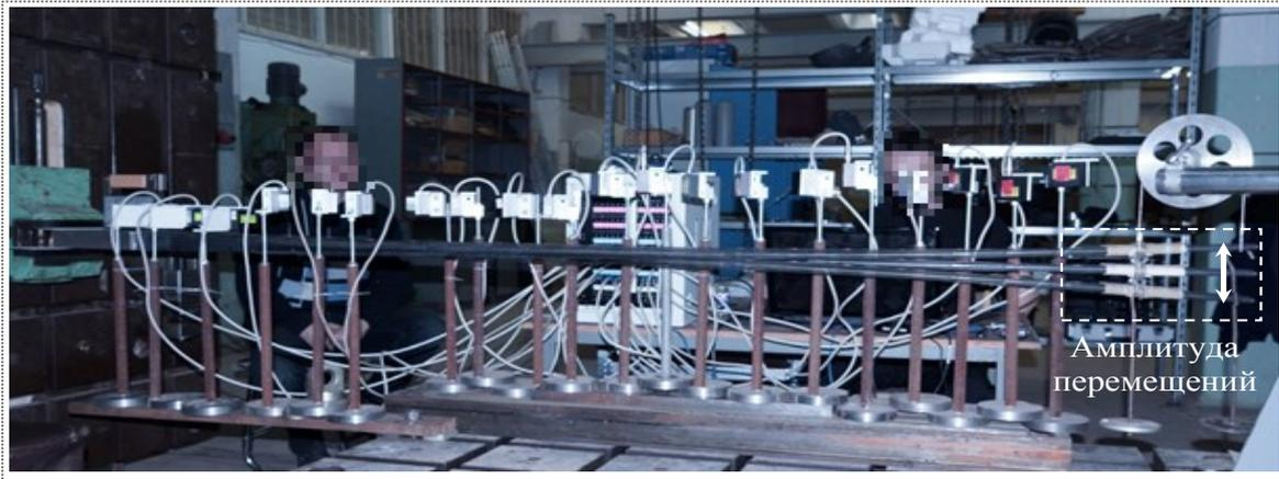
Рисунок 3.2.2 – Лонжерон в процессе проведения жесткостных испытаний
