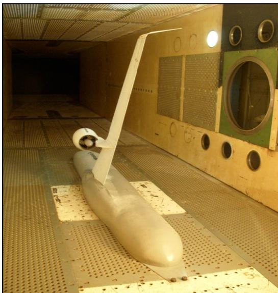
Рисунок 1.2.3 - Многофункциональная ДДПМ крыла большого удлинения в рабочей части АДТ
