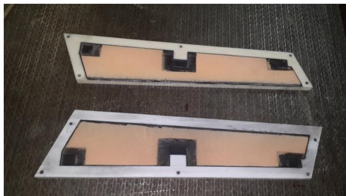
Рисунок 2.3.12 - Две половины элерона, уложенные в прессформы
