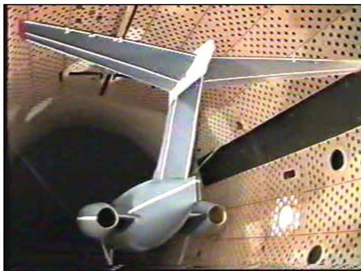
Рисунок 1.2.2 - ДПМ хвостовой части самолёта в трансзвуковой АДТ-106
