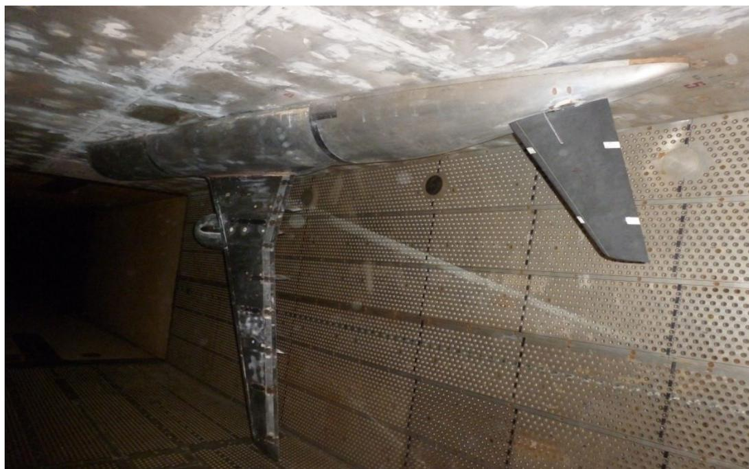
Рисунок 2.4.8 – ДДПМ ГО установленная на аэродинамическую полумодель
