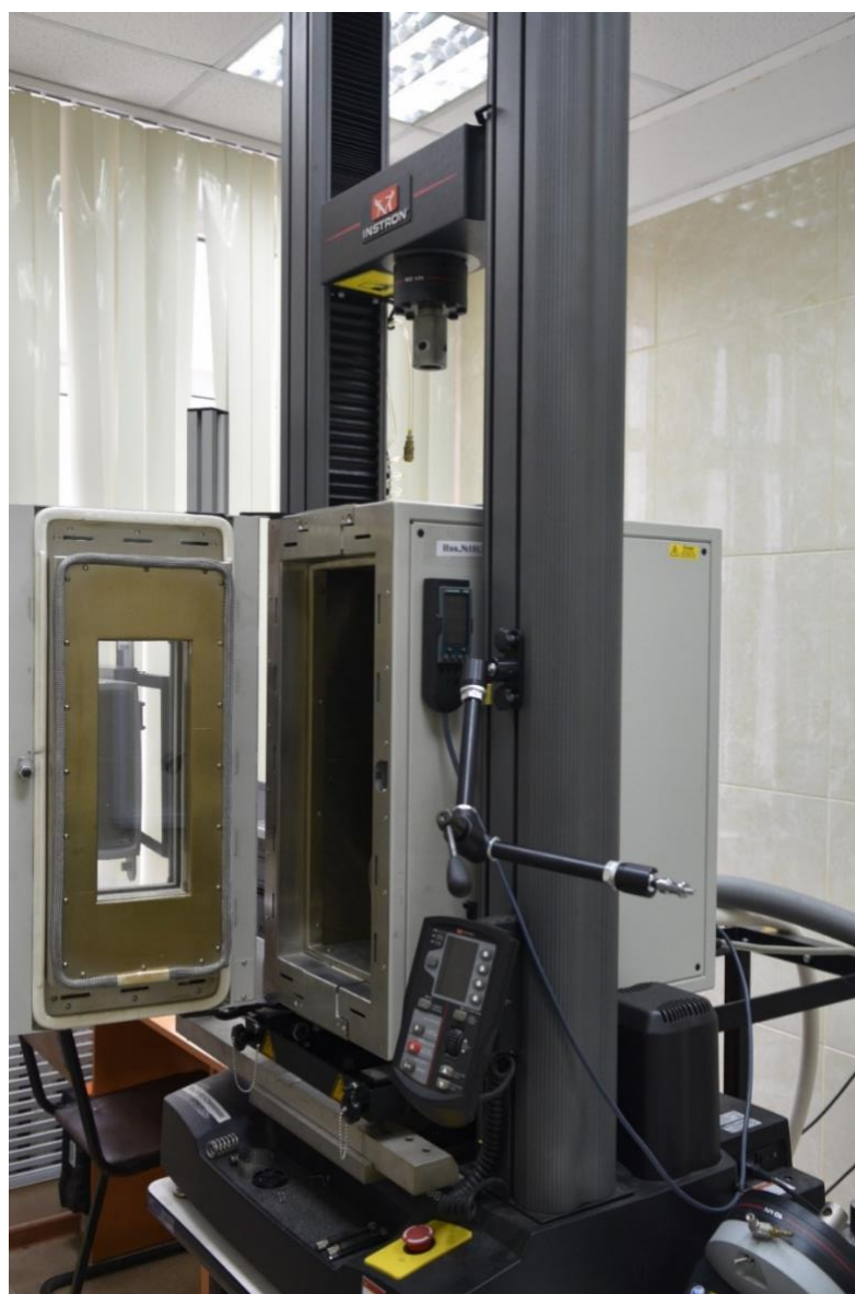
Рисунок 2.4. Общий вид универсальной электрической установки Instron 5969
