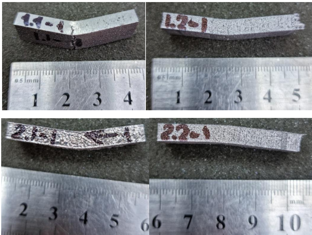
Рисунок 2.15. Характер деформации испытанных образцов.
