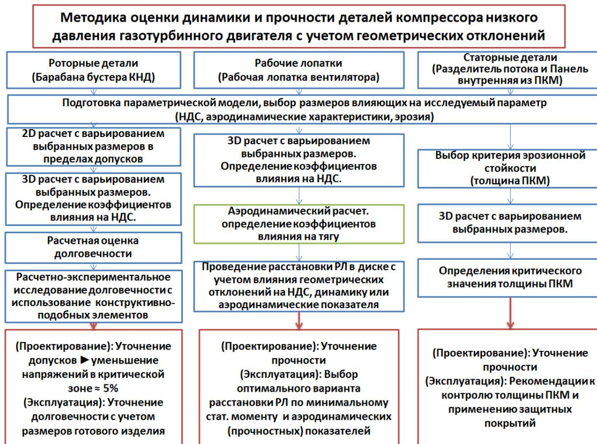
Рисунок 1 – Схема методики для различных деталей ГТД
