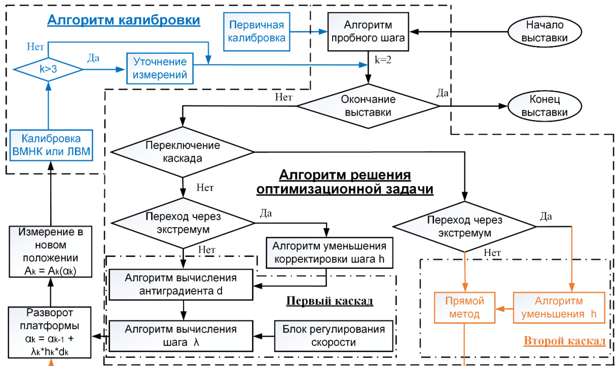
Рисунок 3.2.2 – Блок-схема двухкаскадного алгоритма
