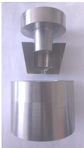
Рисунок 6 - Экспериментальный штамп для изотермического выдавливания
