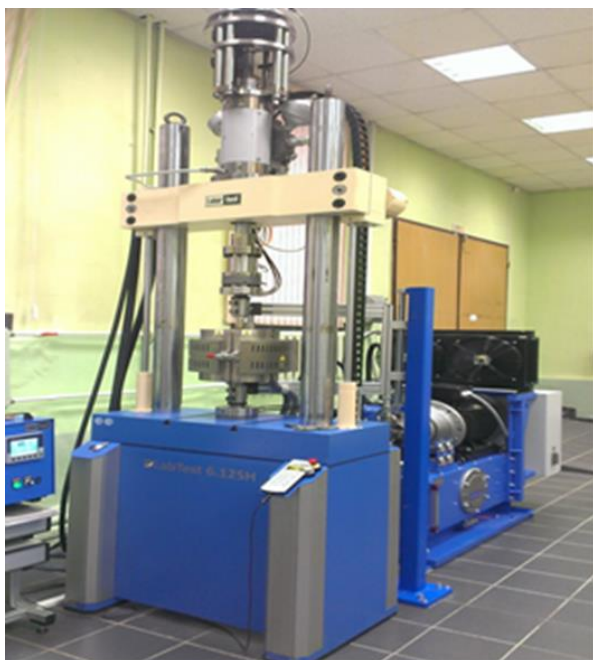
Рисунок 5 - Универсальная испытательная динамическая машина «LABTEST 6.125H.50»
