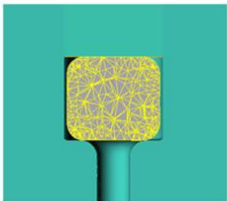
Рисунок 3 – Вид заготовки, разбитой на конечно-элементную сетку
