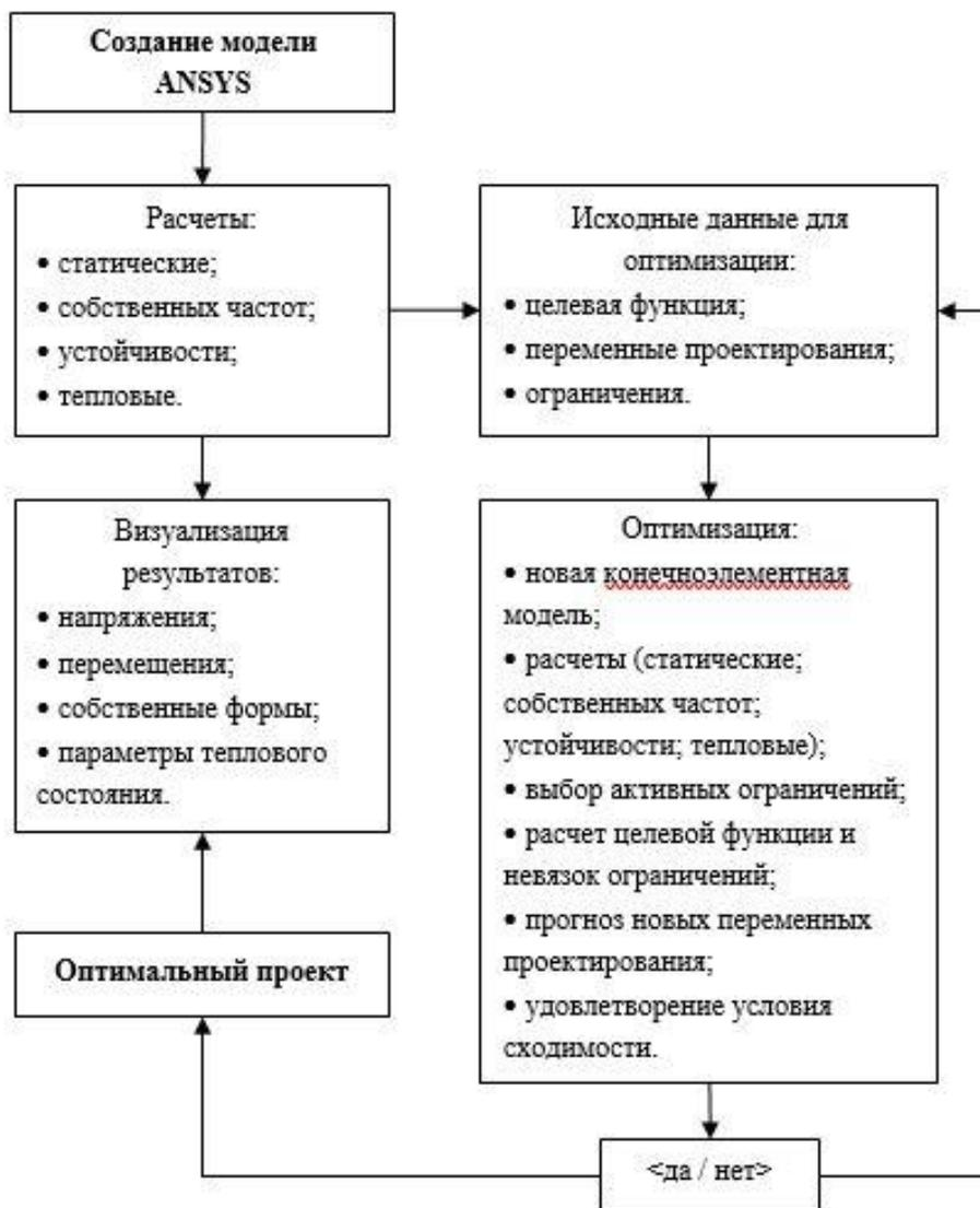
Рисунок 4.1 – Блок-схема оптимизации конструкции.
