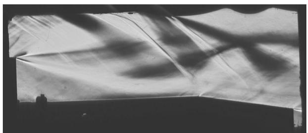
Рисунок 3.61 – Сравнение структуры течения в камере сгорания и модели отсечного клина №5.
