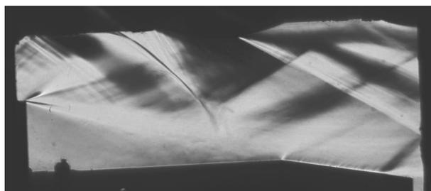
Рисунок 3.58 – Сравнение структуры течения в камере сгорания и модели отсечного клина №2.
