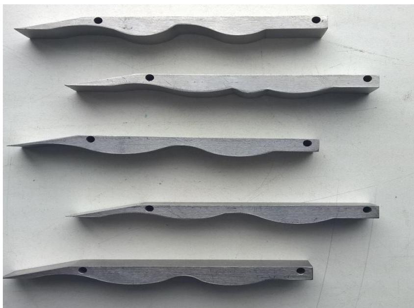
Рисунок 3.14 – Отсечные клинья, изготовленные из стали
