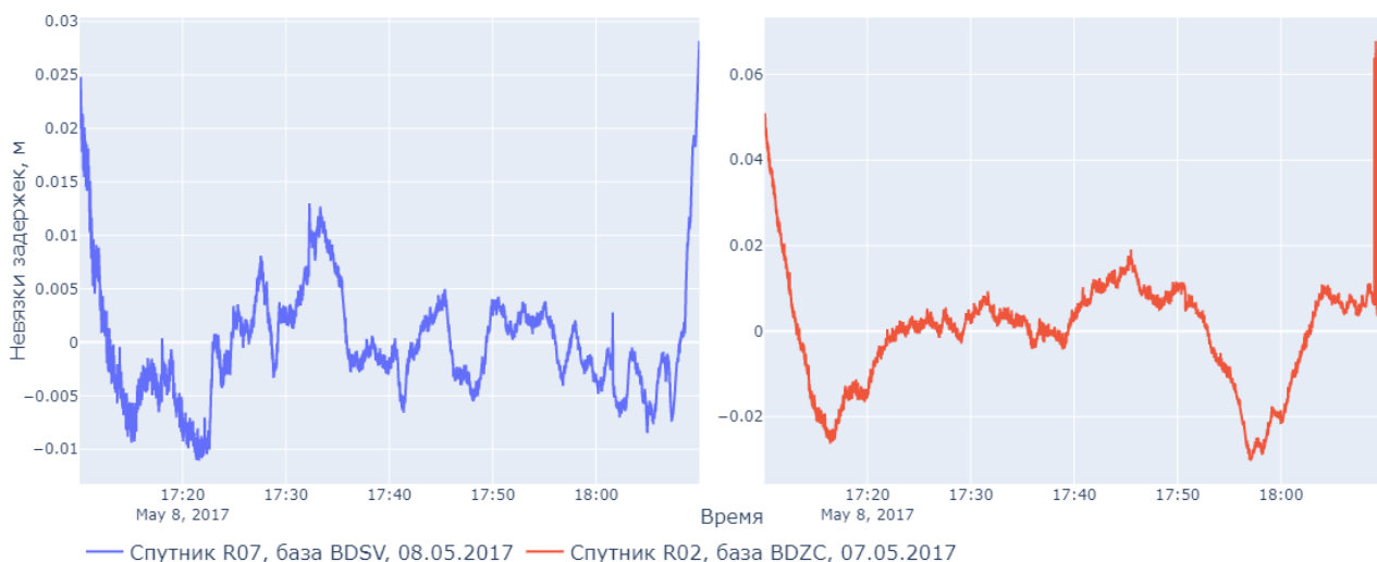
Рис. 12. Невязки расчетных и измеряемых задержек сигналов ГНСС в измерениях РСДБ с учетом входящих в них различных погрешностей
